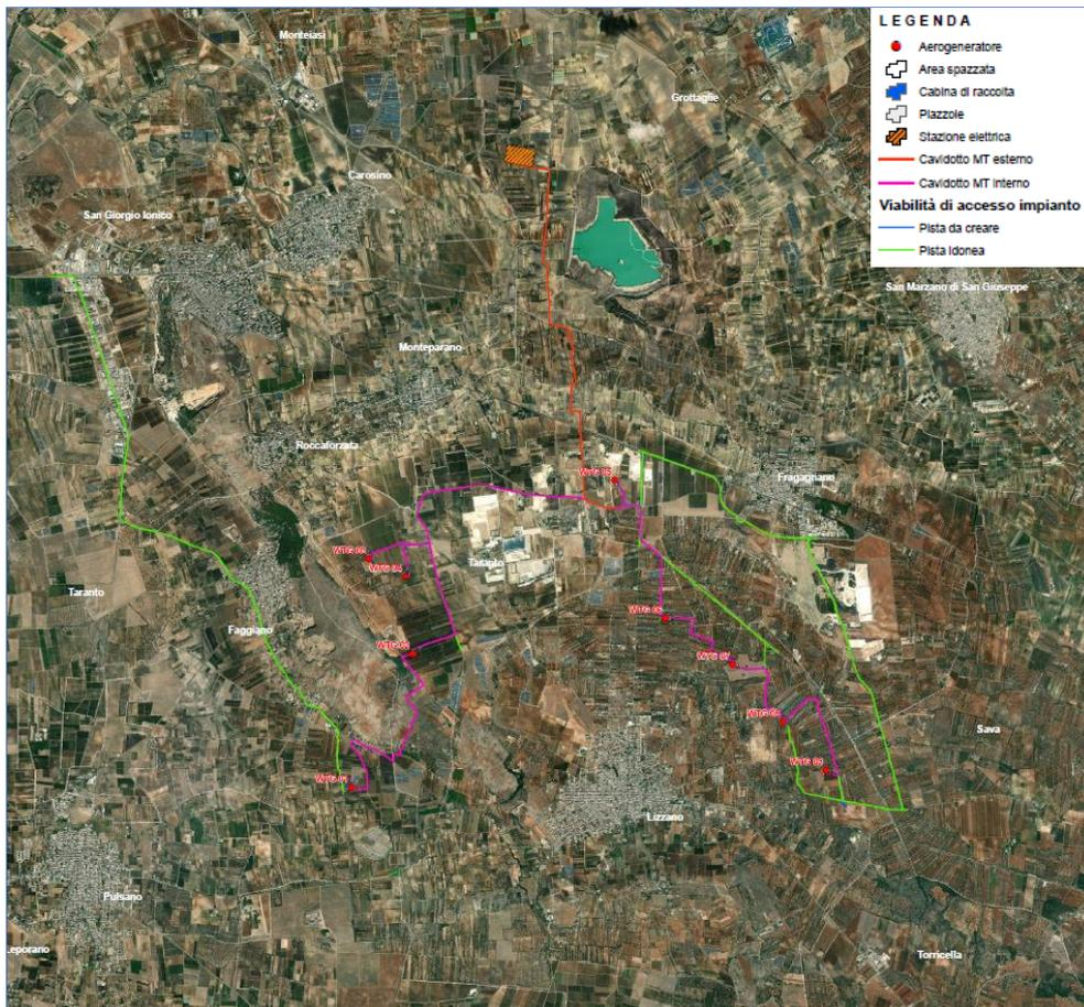
Figura 6 - layout impianto definitivo a n.9 aerogeneratori
