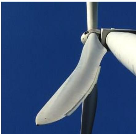
Il rotore è costituito da tre pale, un mozzo e l'azionamento per regolare l'angolo d'orientamento delle pale (Controllo di Passo). Le pale sono tipicamente costituite da fibre composite a base di vetroresina rinforzata.
