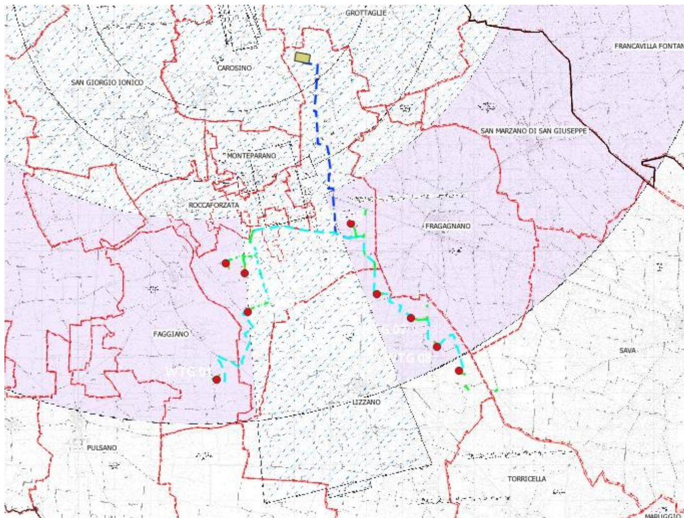
*Figura 7 - Stralcio Planimetria Interferenza del Parco Eolico con l'aeroporto di Taranto-Grottaglie*
