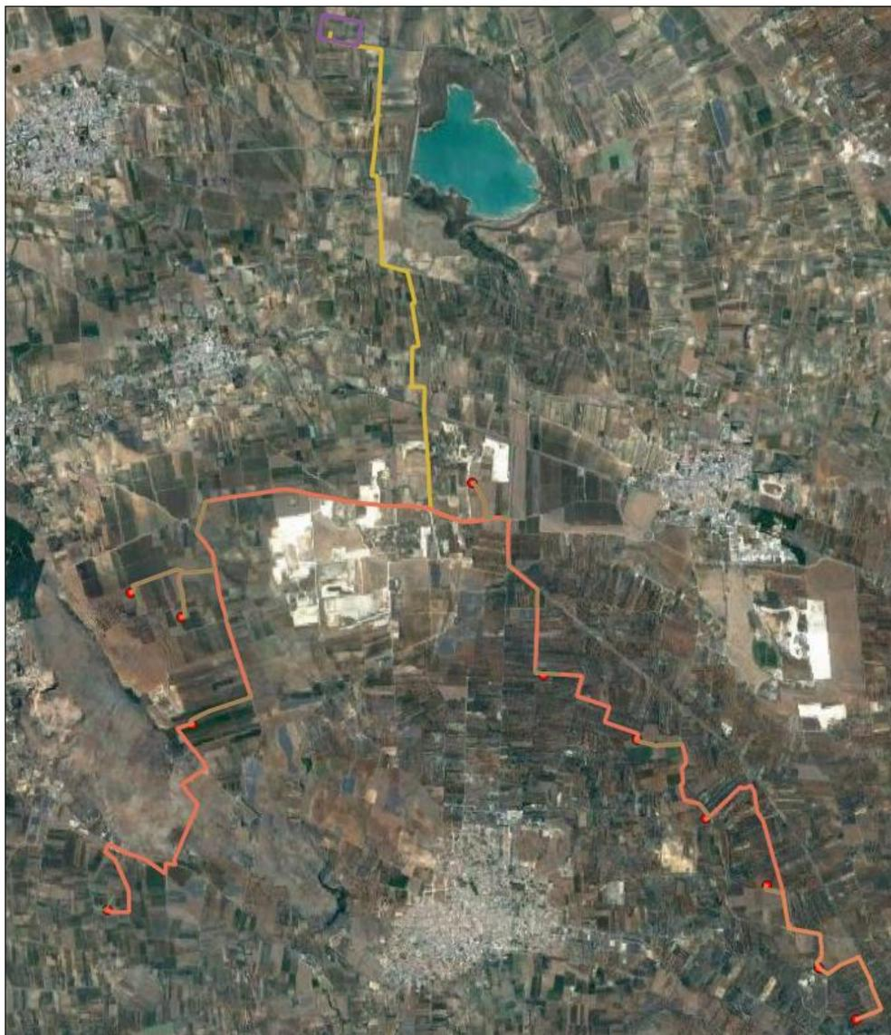
*Figura 4 - Ipotesi di layout a 11 aerogeneratori*
