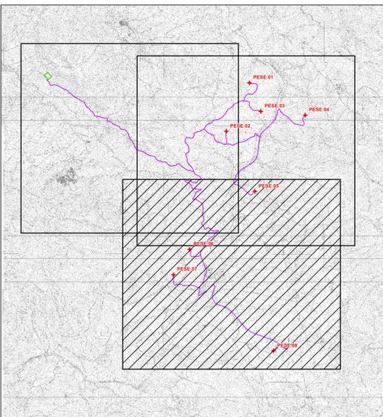
★ Aerogeneratore in progetto
