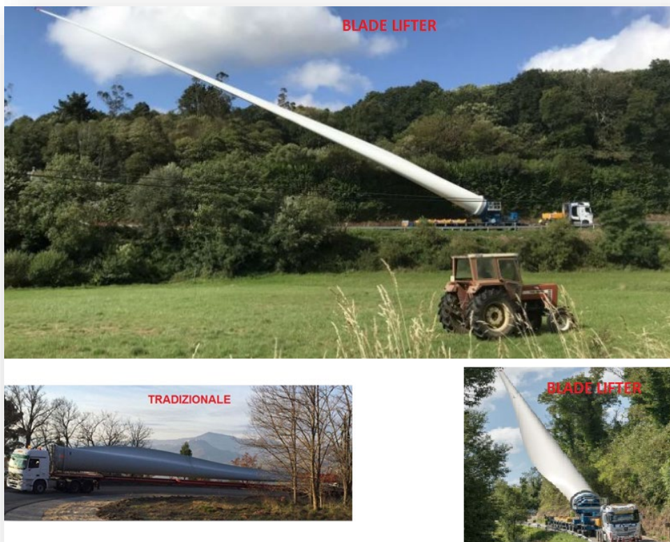
Figura 25 – esempi di trasporto tradizionale e soluzione con cambio della configurazione di carico durante il percorso (blade lifter)
