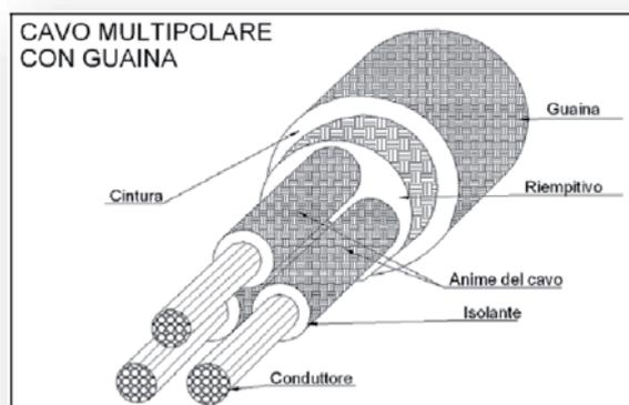
Figura 1 - Cavo multipolare con guaina
