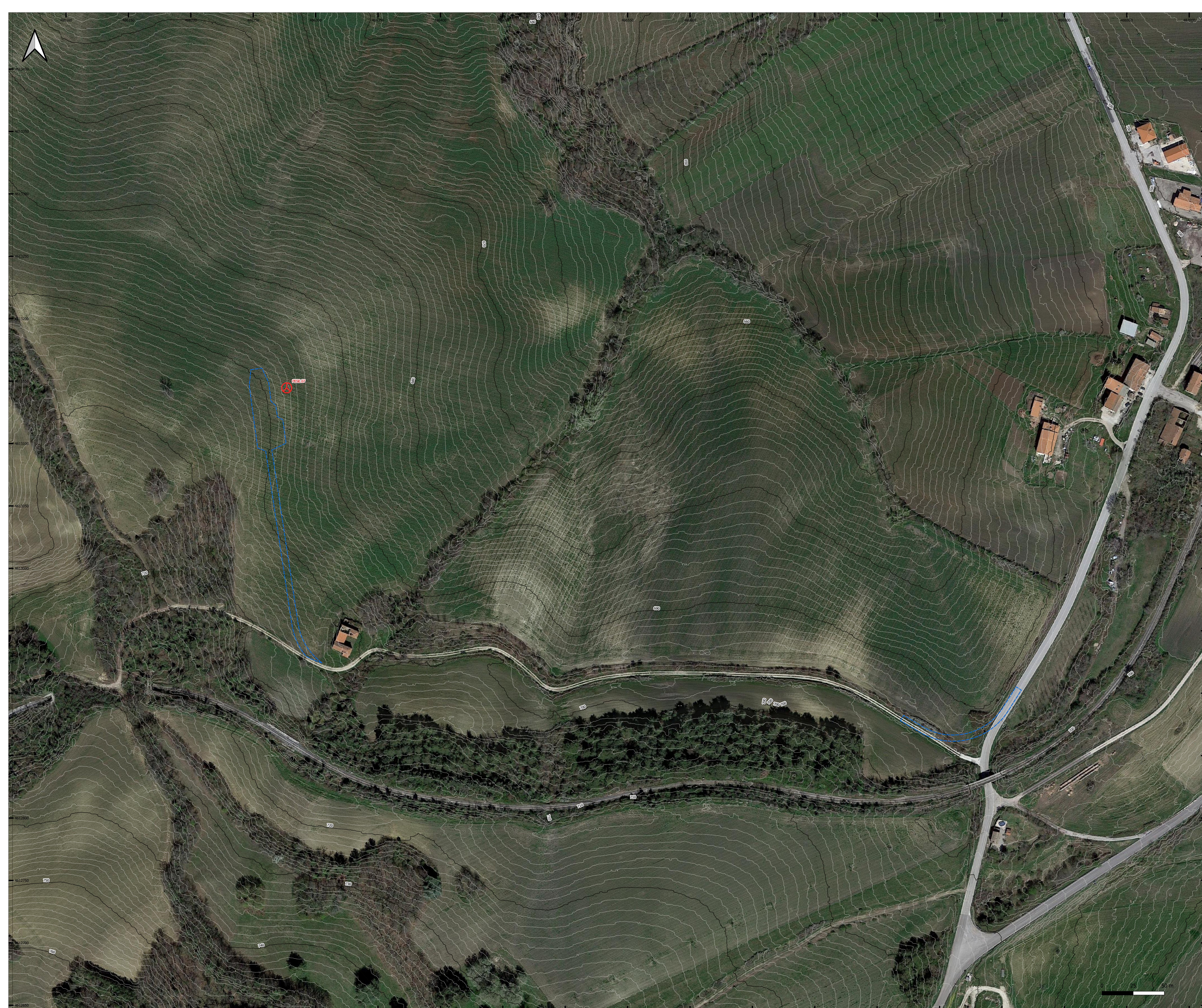
Curve di livello interdistanti 1 metro acquisite da rilievo LIDAR fornito dal Geoportale Nazionale
