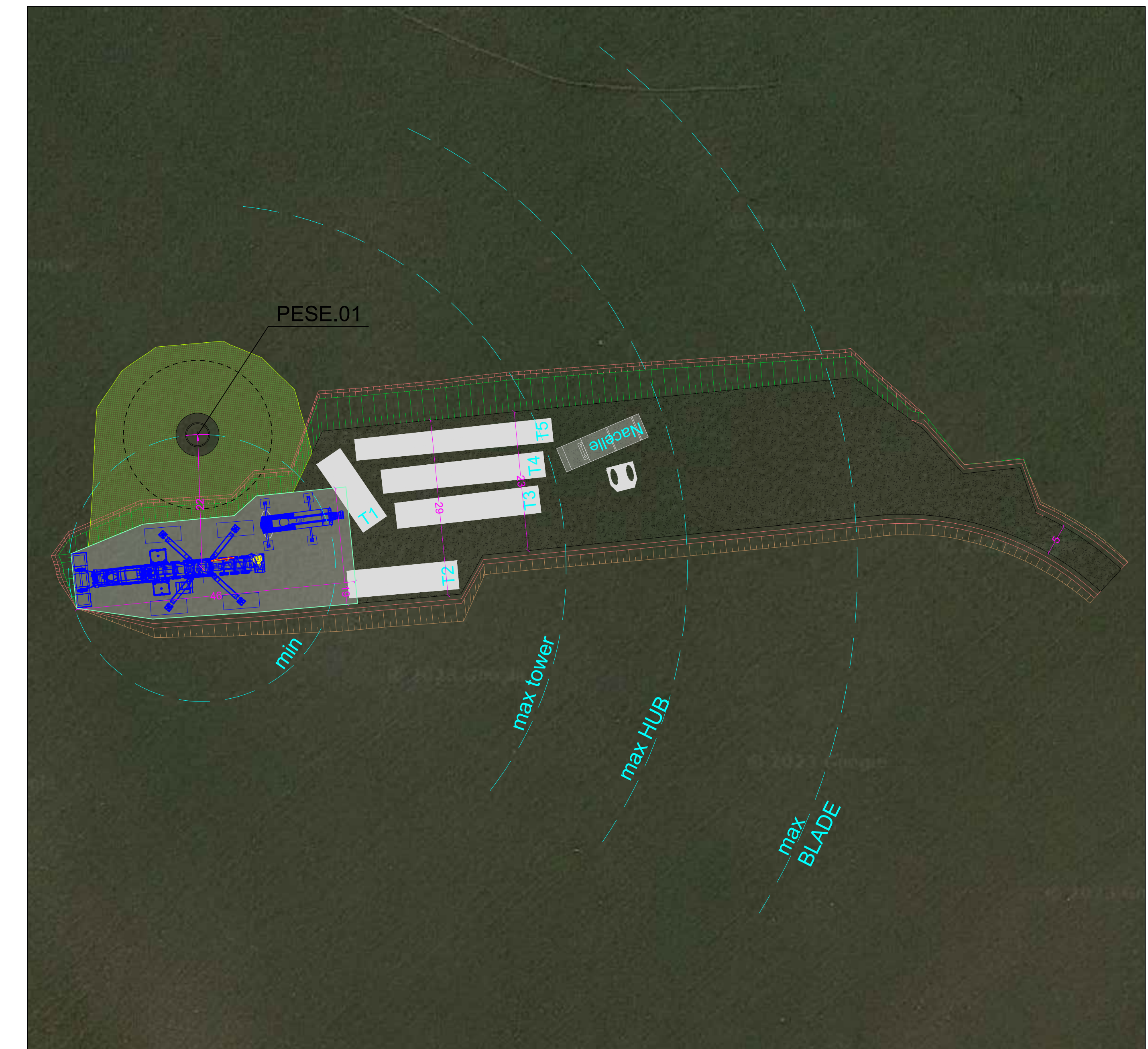
CONFIGURAZIONE 3- MONTAGGIO TRAMI E NAVICELLA - SCALA 1:500
