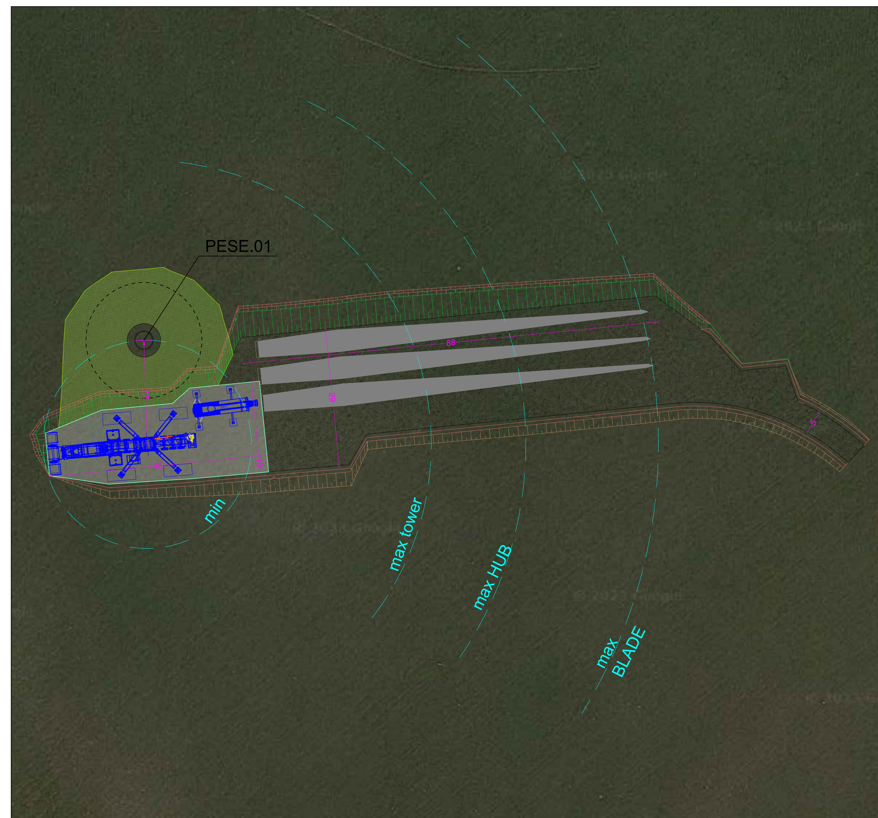
CONFIGURAZIONE 4 - MONTAGGIO LAME - SCALA 1:500
