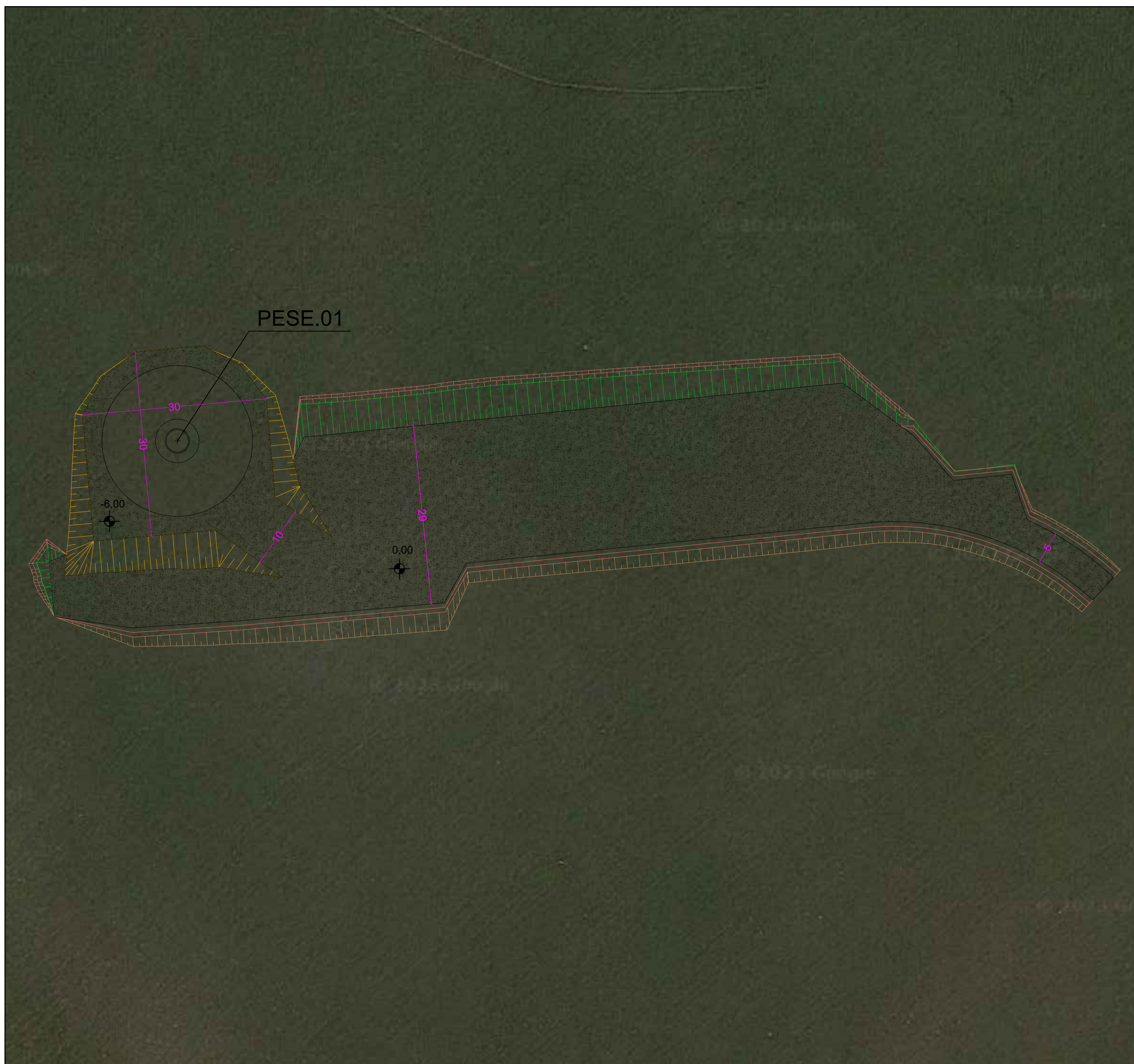
CONFIGURAZIONE 1 - SCAVO DI FONDAZIONE - SCALA 1:500
