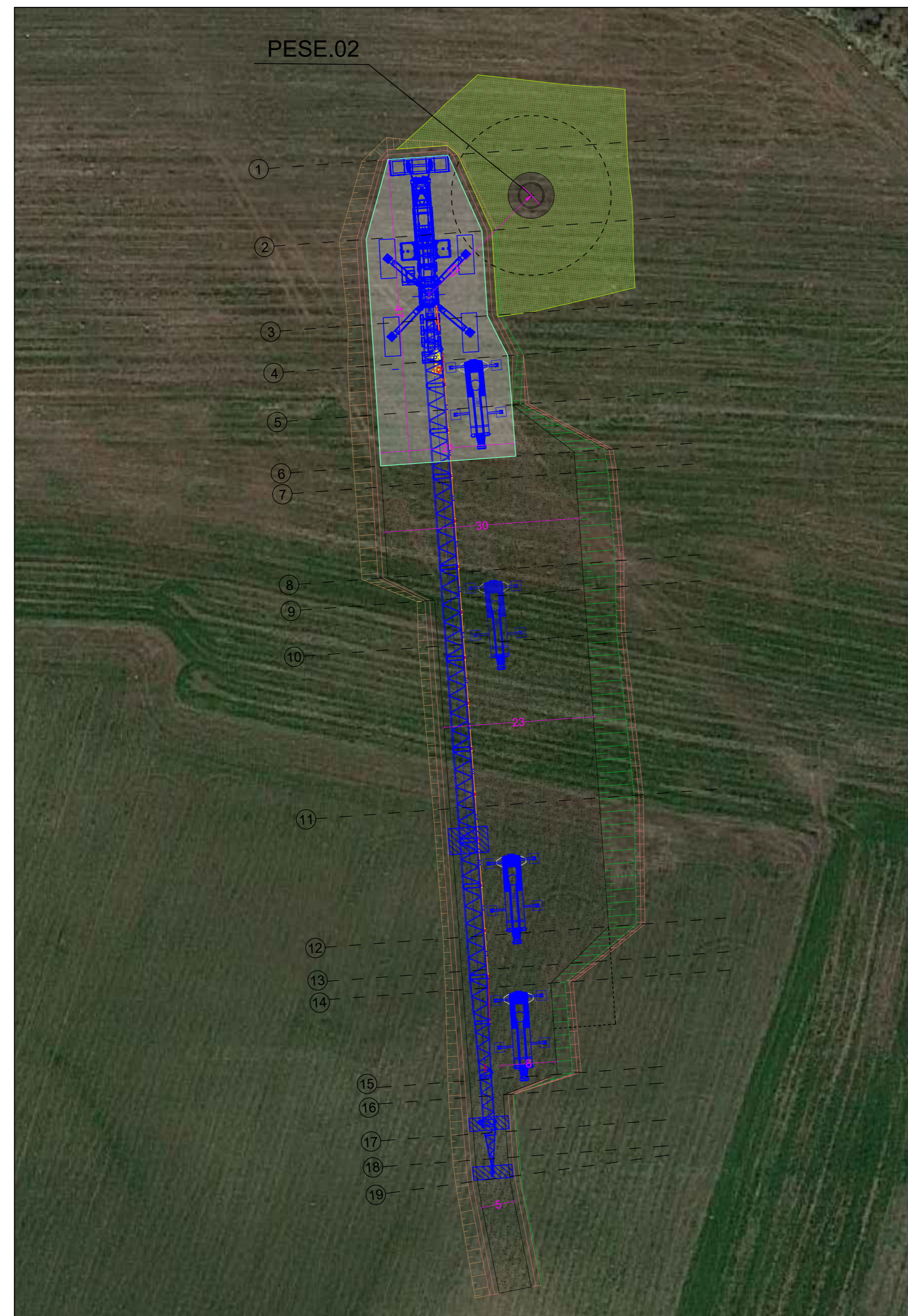
CONFIGURAZIONE 2 - MONTAGGIO GRU TRALICCIATA SCALA 1:500
