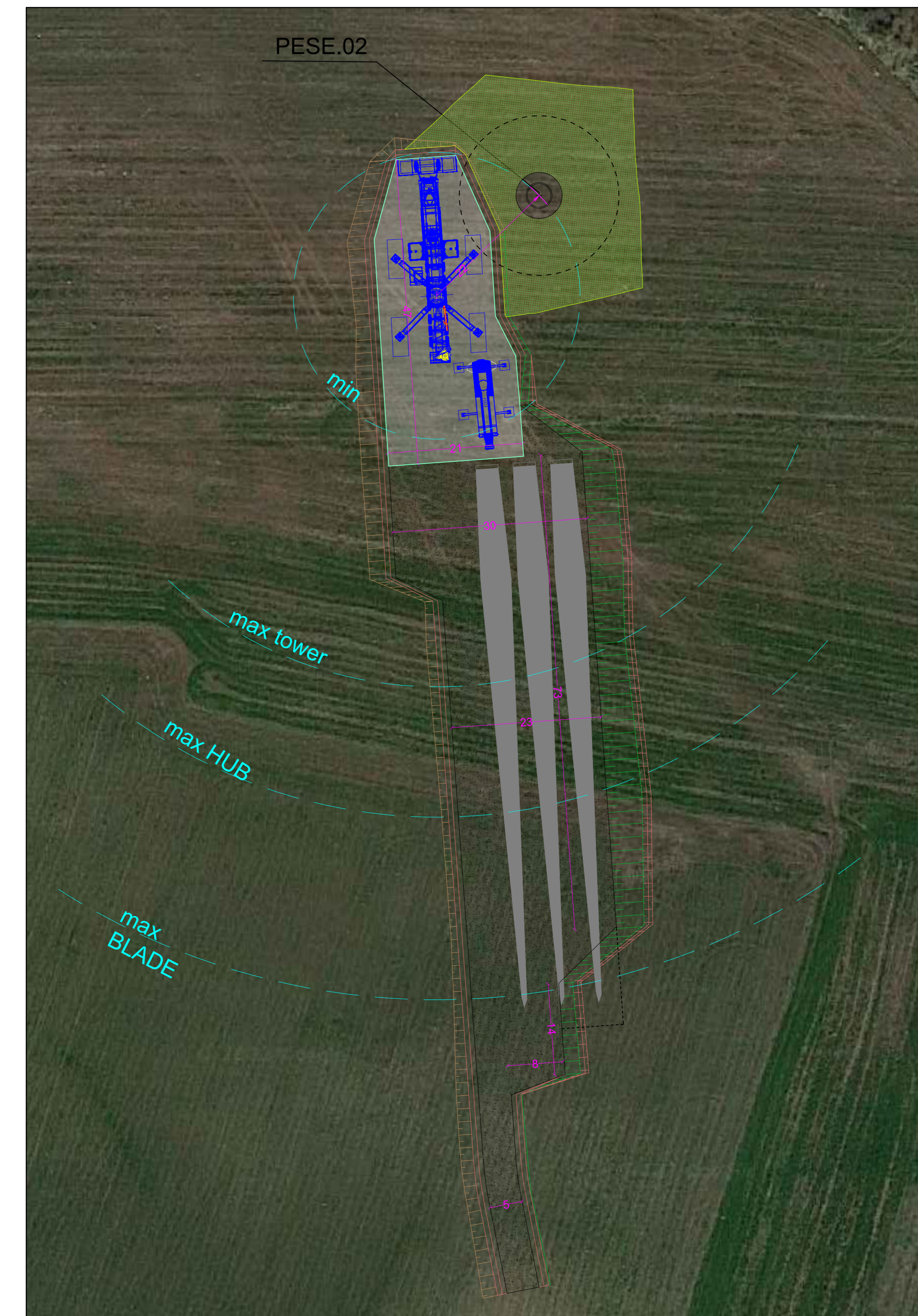
CONFIGURAZIONE 4 - MONTAGGIO LAME SCALA 1:500
