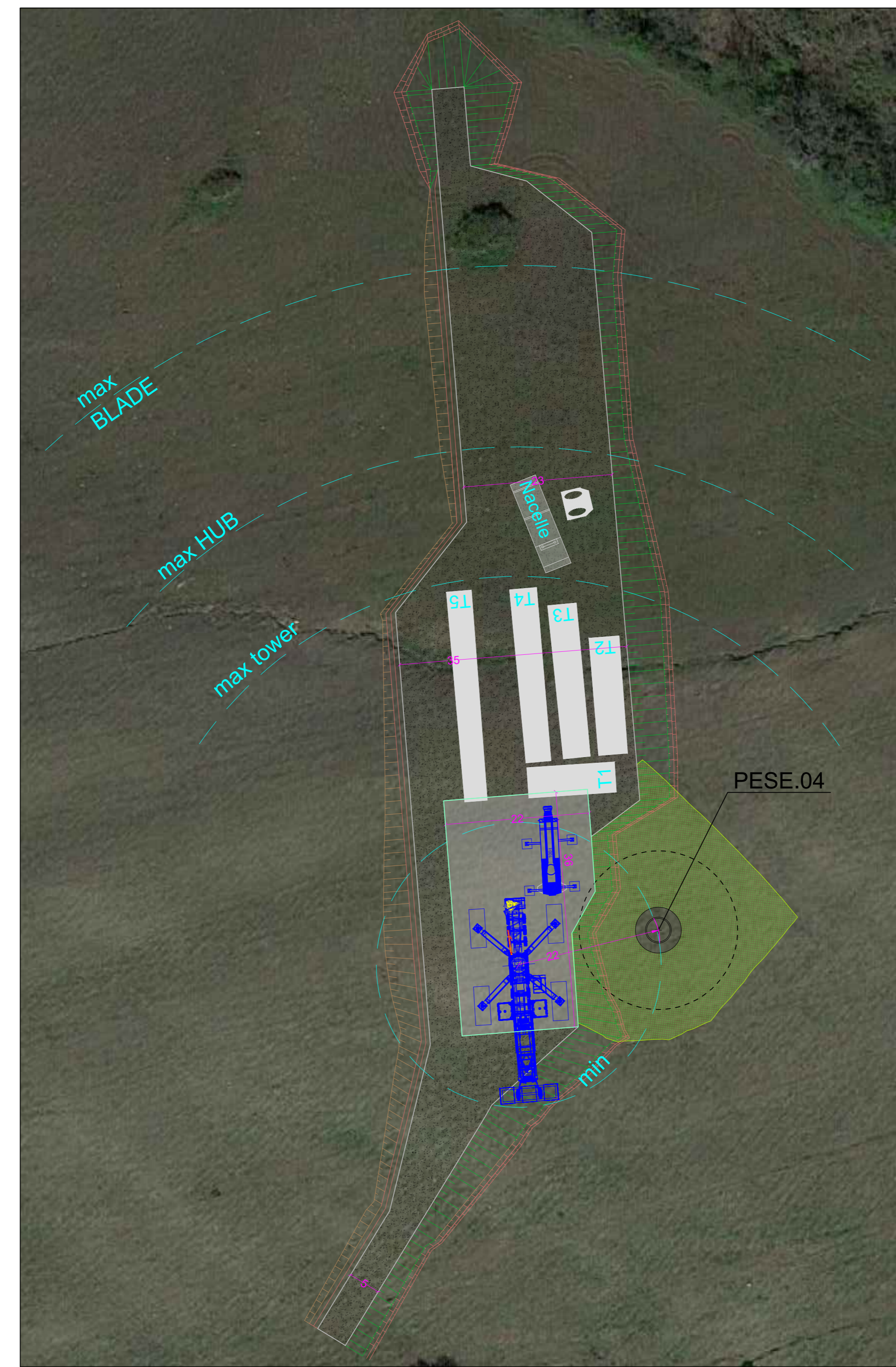
CONFIGURAZIONE 3- MONTAGGIO TRAMI E NAVICELLA SCALA 1:500
