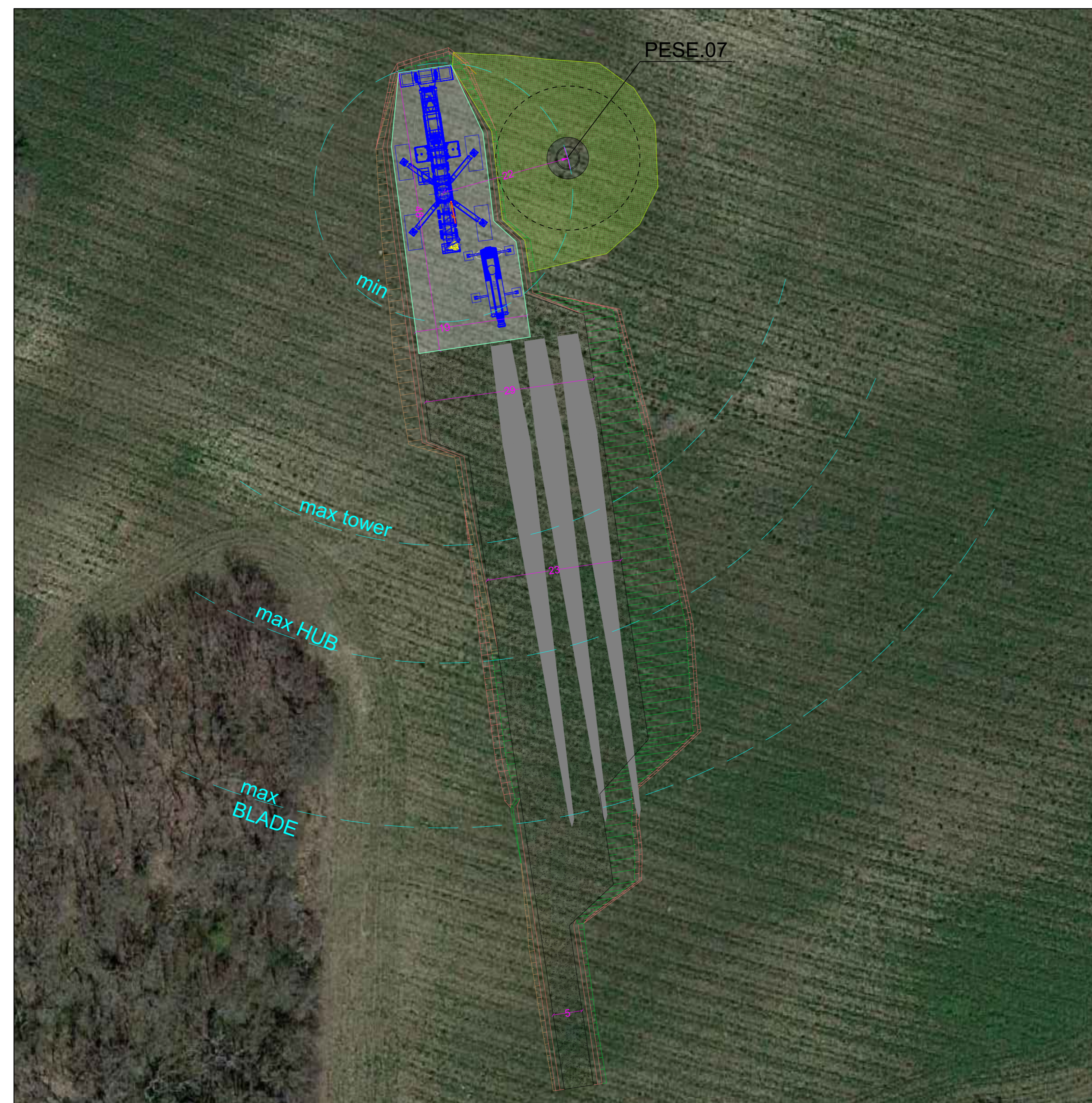
CONFIGURAZIONE 4 - MONTAGGIO LAME - SCALA 1:500
