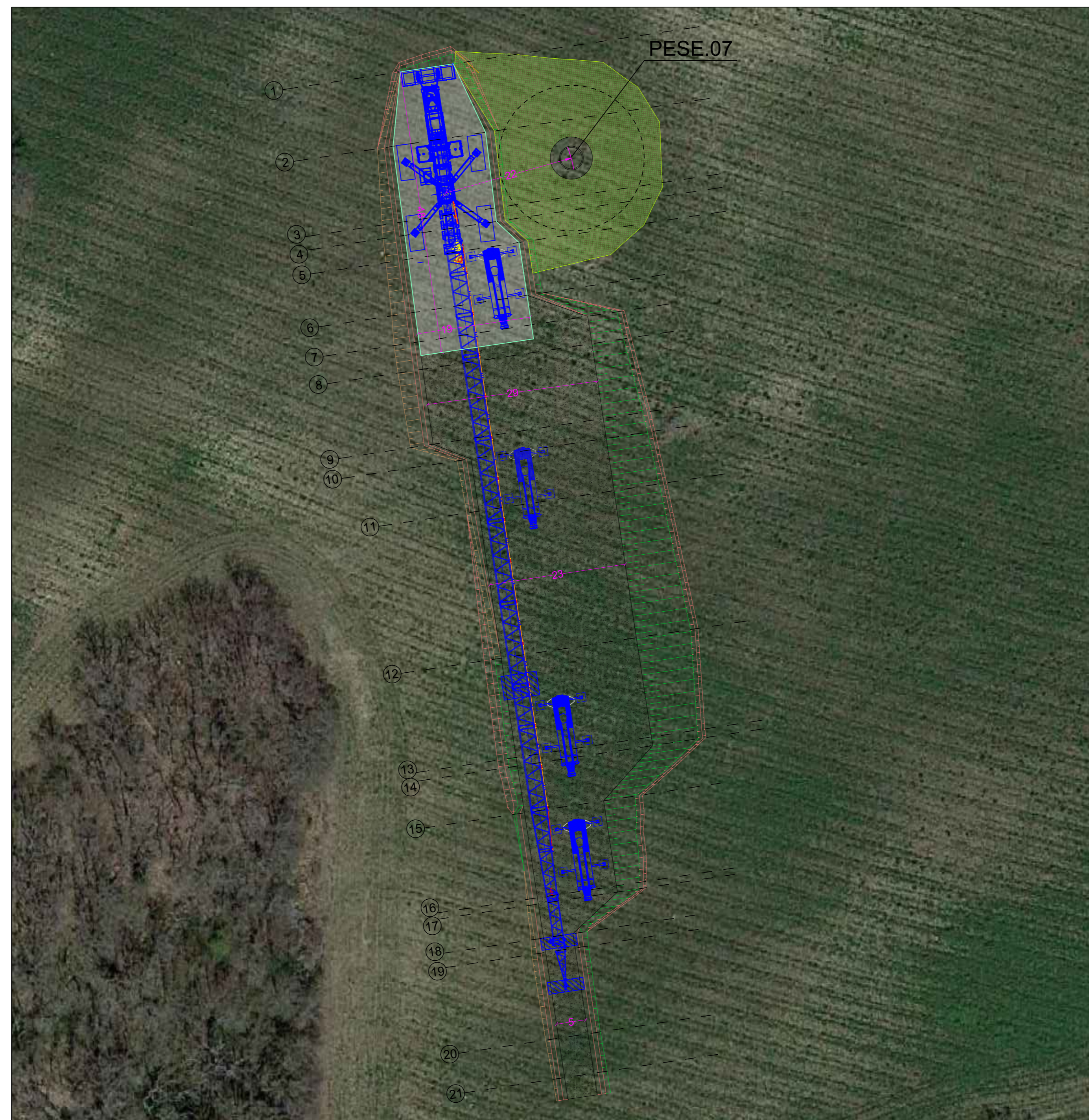
CONFIGURAZIONE 2 - MONTAGGIO GRU TRALICCIATA - SCALA 1:500
