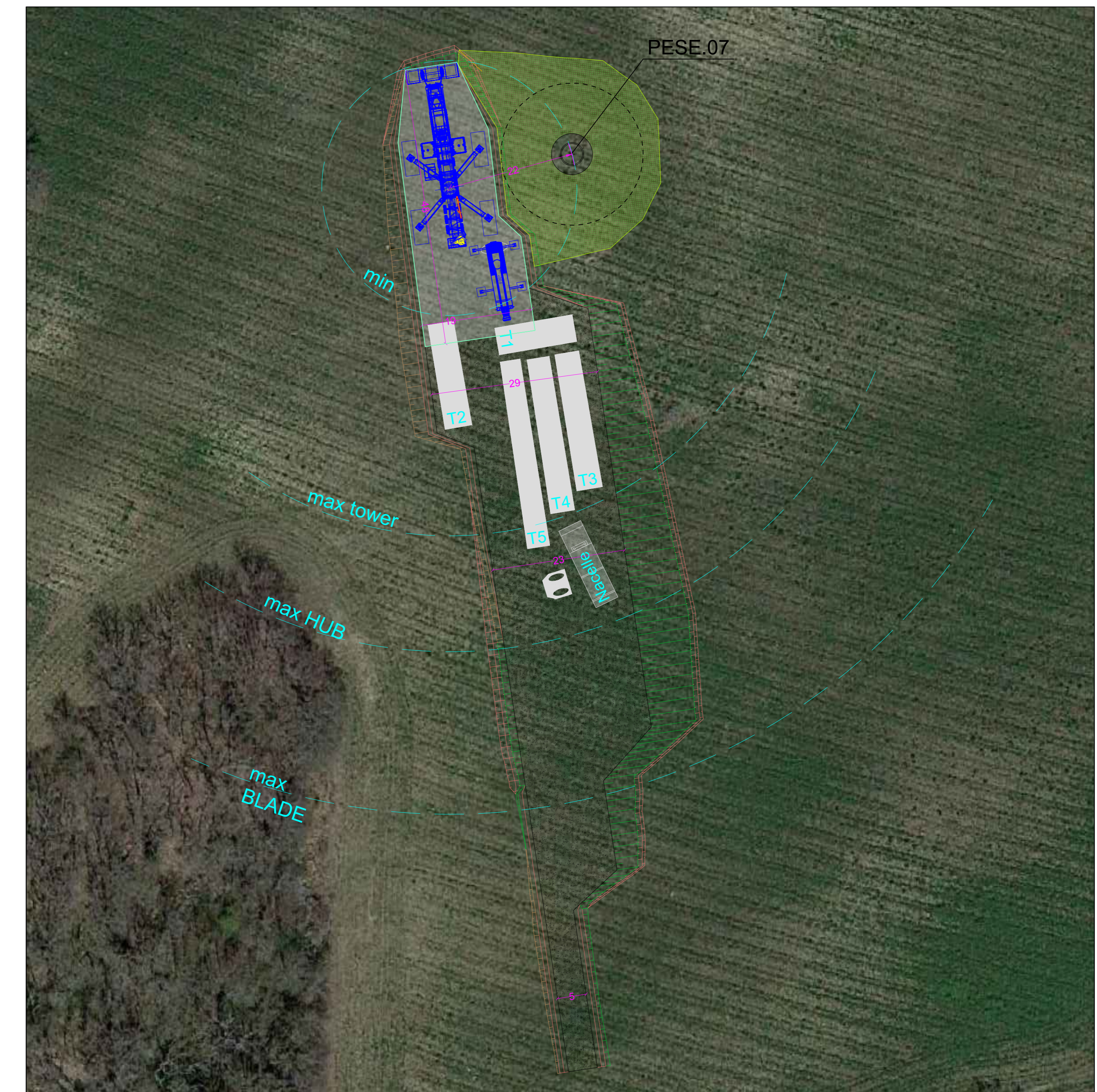
CONFIGURAZIONE 3- MONTAGGIO TRAMI E NAVICELLA - SCALA 1:500
