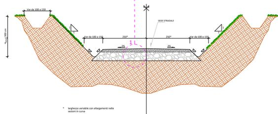
SEZIONE TIPO - STRADA DI NUOVA REALIZZAZIONE IN TRINCEA SCALA 1:100
