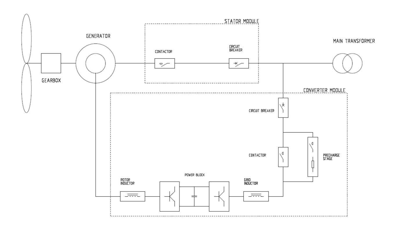
Schema funzionale tipo Aerogeneratore SG 170
