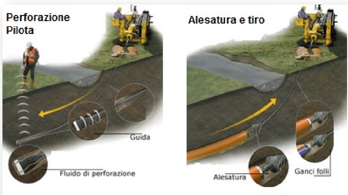
Figura 31 - Tecnologia di trivellazione orizzontale controllata (TOC)
