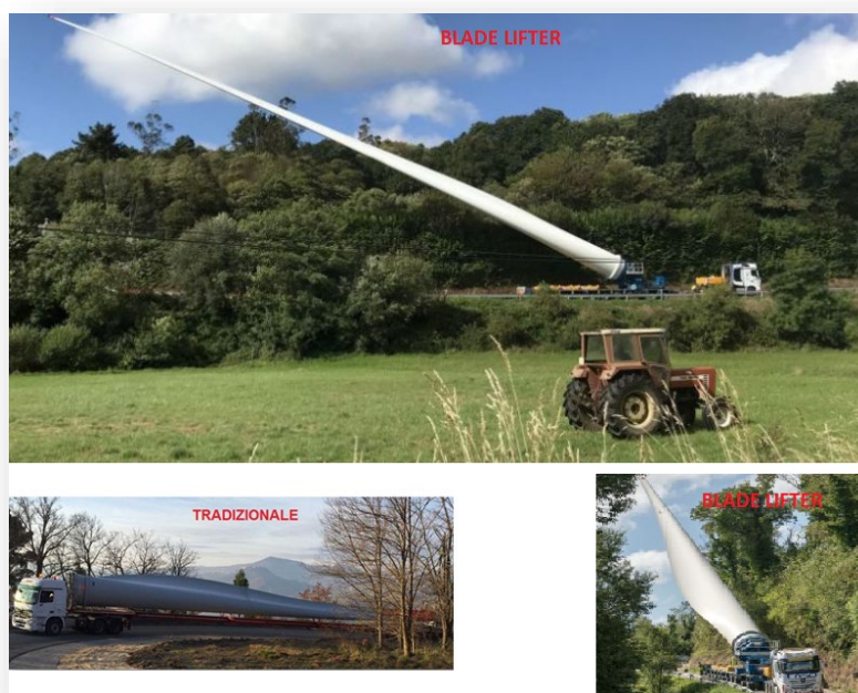
Figura 19 - esempi di trasporto tradizionale e soluzione con cambio della configurazione di carico durante il percorso (blade lifter)
