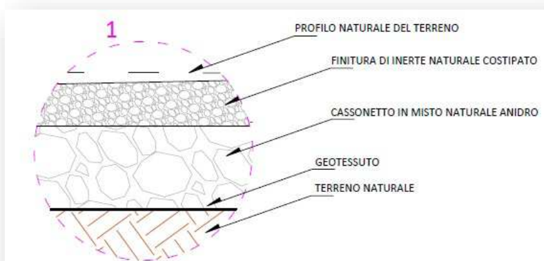
Figura 22 - schema rappresentativo del pacchetto stradale
