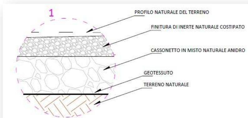
Figura 27 - schema rappresentativo del pacchetto stradale
