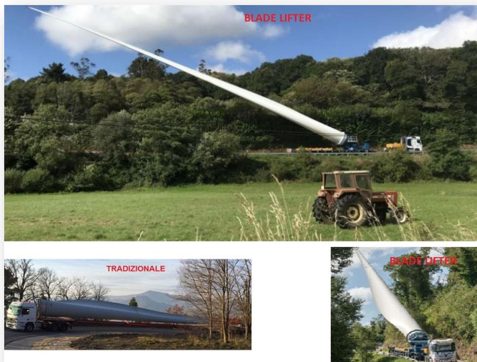
*Figura 24 – esempi di trasporto tradizionale e soluzione con cambio della configurazione di carico durante il percorso (blade lifter)*
