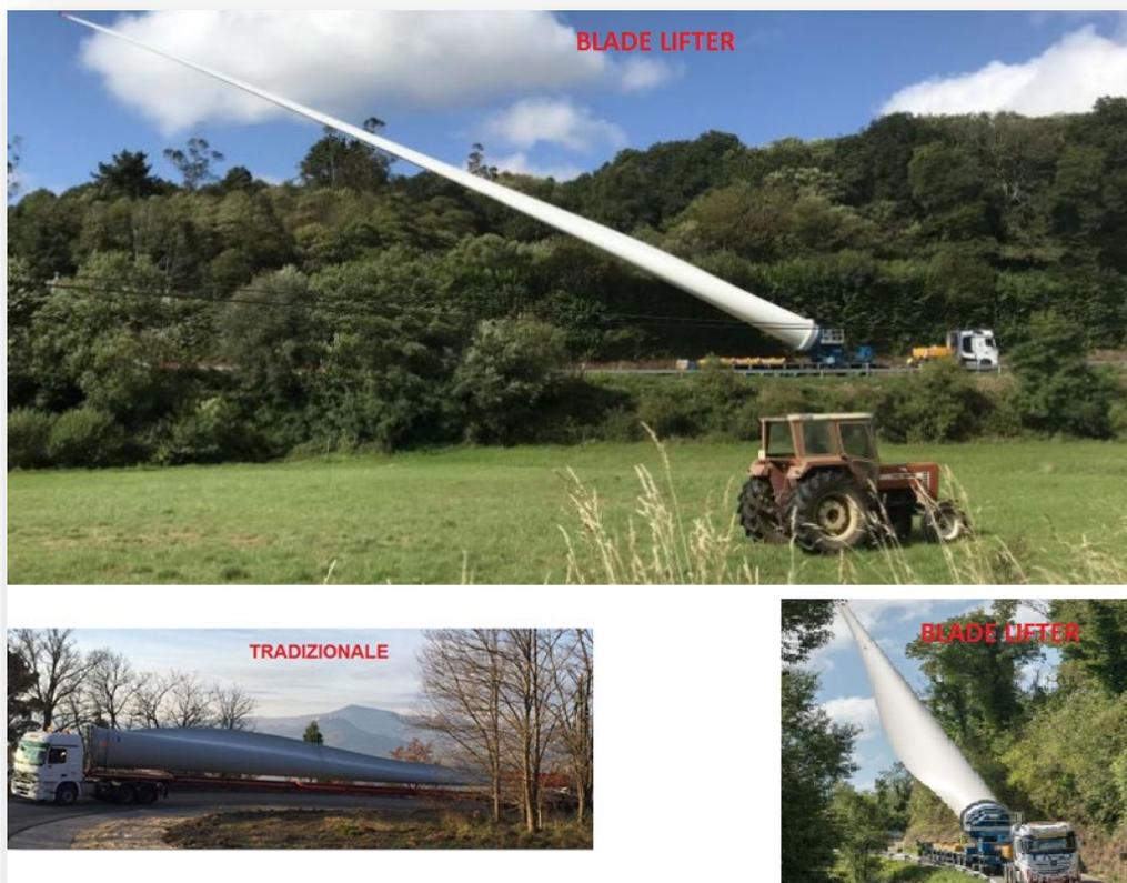
Figura 32 – esempi di trasporto tradizionale e soluzione con cambio della configurazione di carico durante il percorso (blade lifter)
