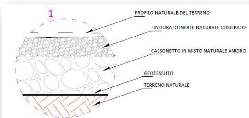
Figura 35 - schema rappresentativo del pacchetto stradale
