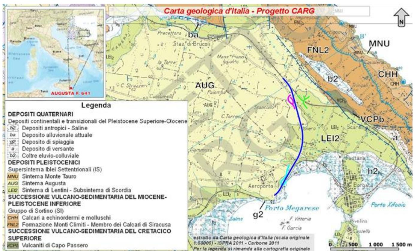
Figura 5-4 Stralcio del foglio CARG n. 641 "Augusta" in scala 1:50000 (ISPRA 2011) con indicazione delle opere in progetto
