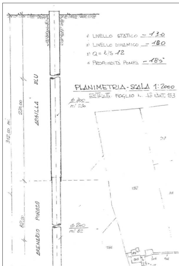
Figura 12 - Stratigrafia terreni adiacenti Pozzo Serena
