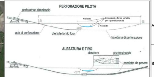
Modalità generica di risoluzione delle interferenze (attraversamento canali irrigui/di scolo con tecnica TOC)
