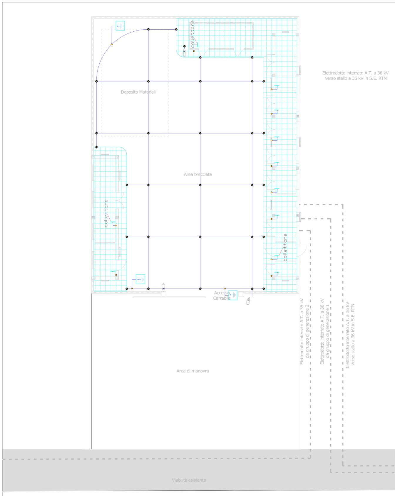
Elettrodotto interrato A.T. a 36 kV verso stallo a 36 kV in S.E. RTN
