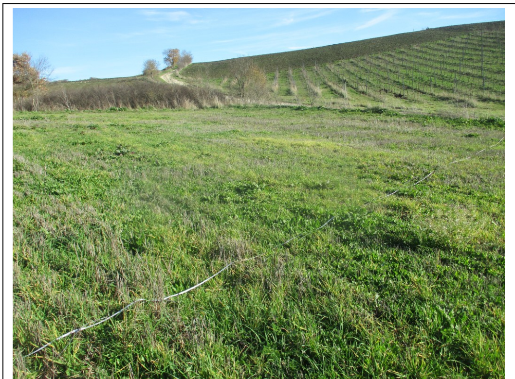
Esecuzione indagine sismica a rifrazione n. 7 e Masw n. 7 sullo stesso stendimento
