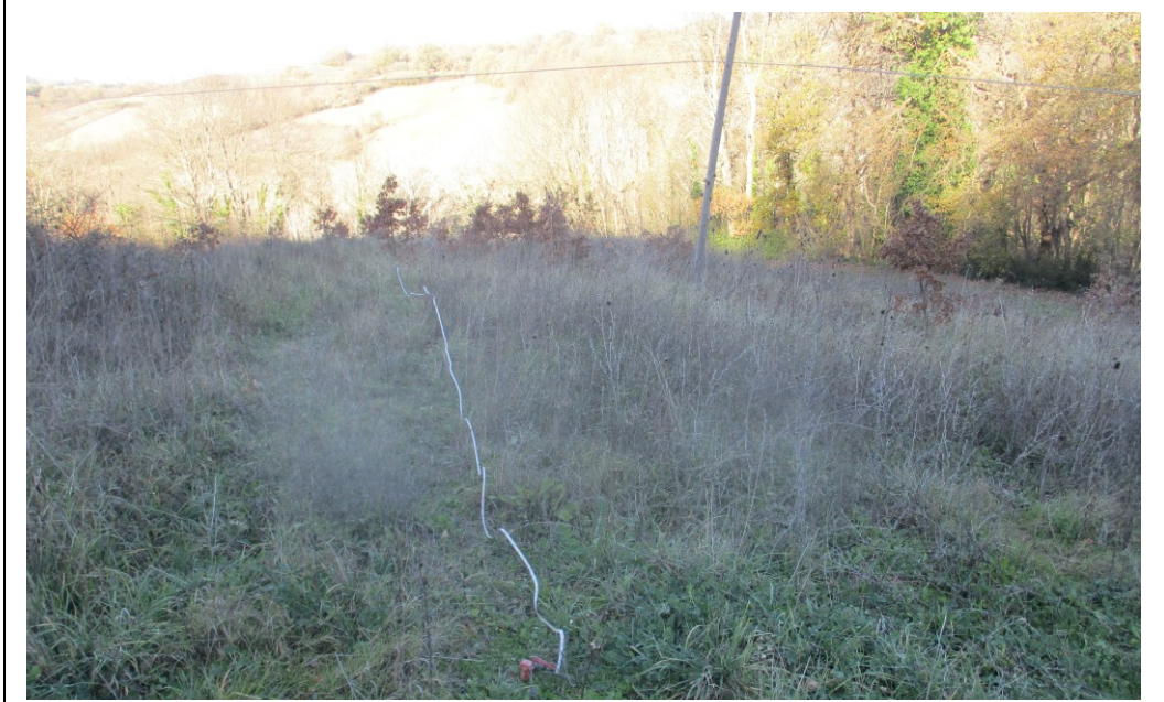
Esecuzione indagine sismica a rifrazione n. 4 e Masw n. 4 sullo stesso stendimento
