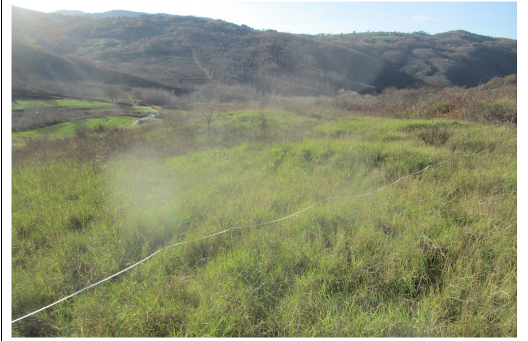
Esecuzione indagine sismica a rifrazione n. 8 e Masw n. 8 sullo stesso stendimento
