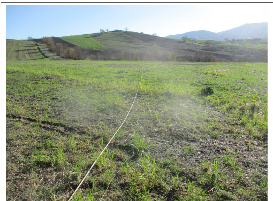
Esecuzione indagine sismica a rifrazione n. 6 e Masw n. 6 sullo stesso stendimento
