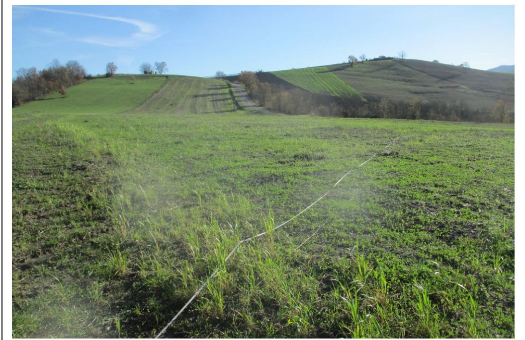
Esecuzione indagine sismica a rifrazione n. 6 e Masw n. 6 sullo stesso stendimento
