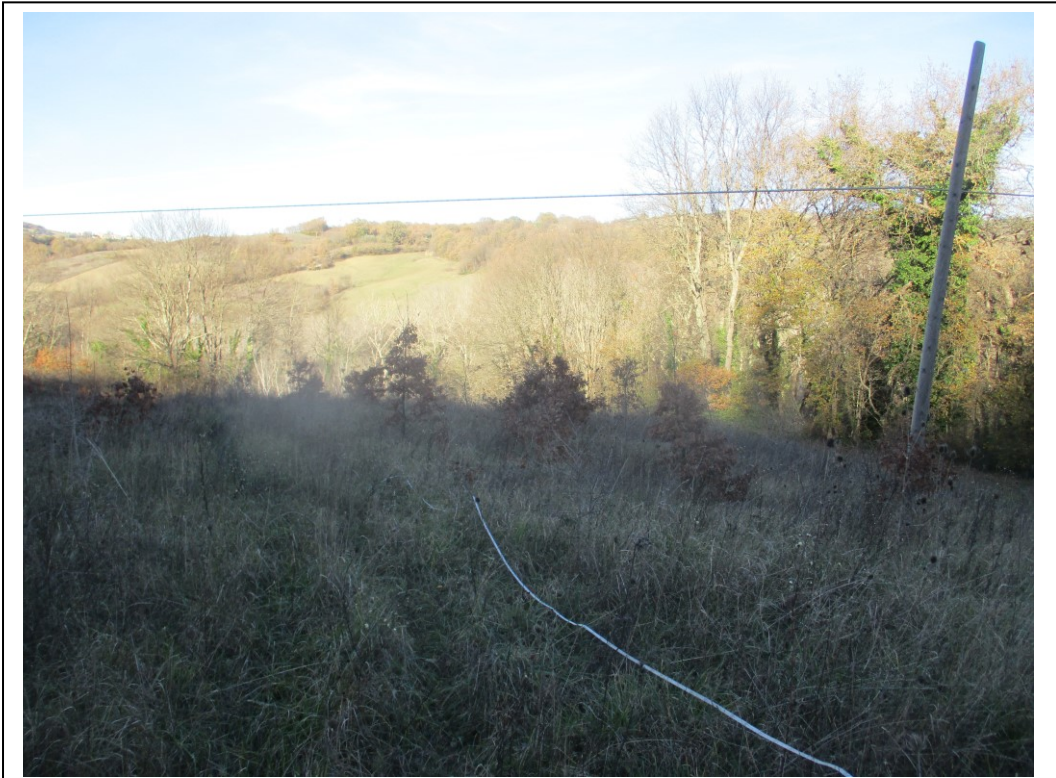
Esecuzione indagine sismica a rifrazione n. 8 e Masw n. 8 sullo stesso stendimento
