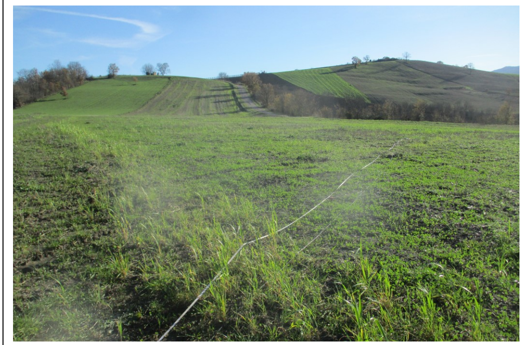
Esecuzione indagine sismica a rifrazione n. 7 e Masw n. 7 sullo stesso stendimento
