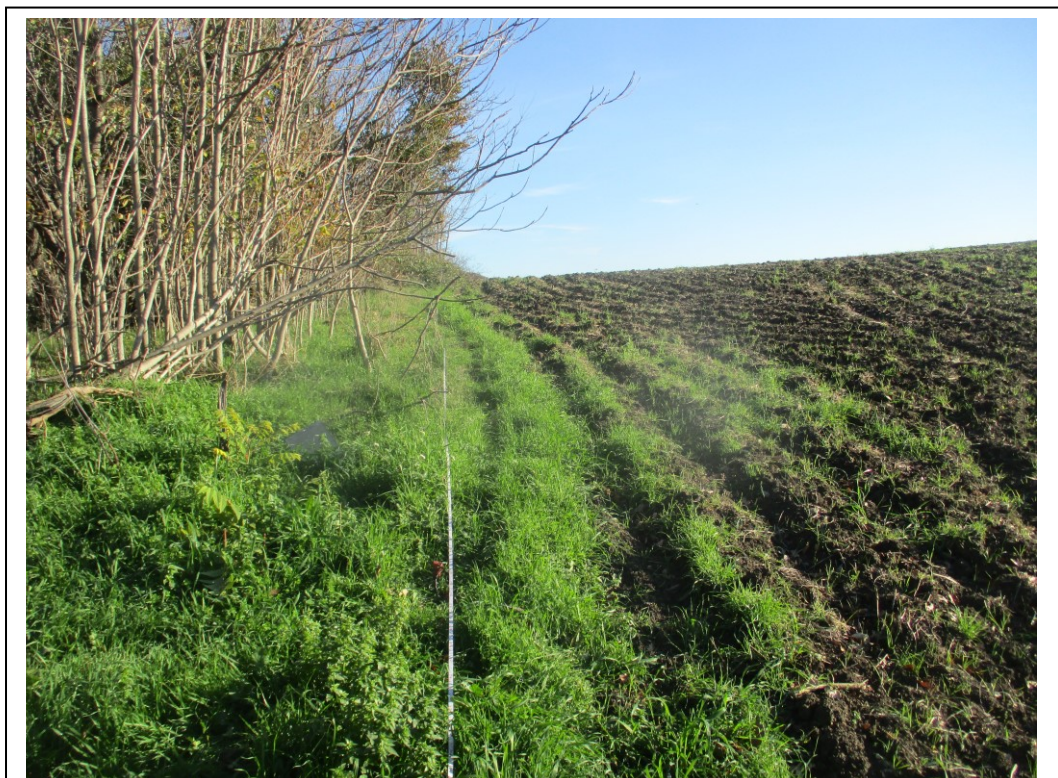
Esecuzione indagine sismica a rifrazione n. 10 e Masw n. 10 sullo stesso stendimento
