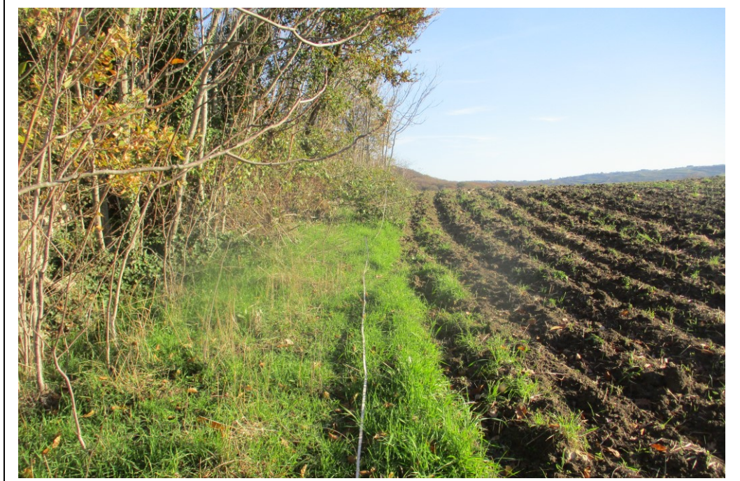
Esecuzione indagine sismica a rifrazione n. 10 e Masw n. 10 sullo stesso stendimento
