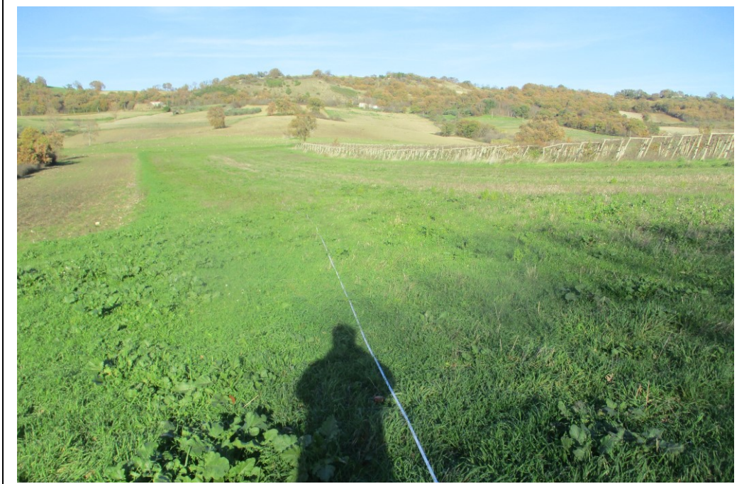
Esecuzione indagine sismica a rifrazione n. 9 e Masw n. 9 sullo stesso stendimento
