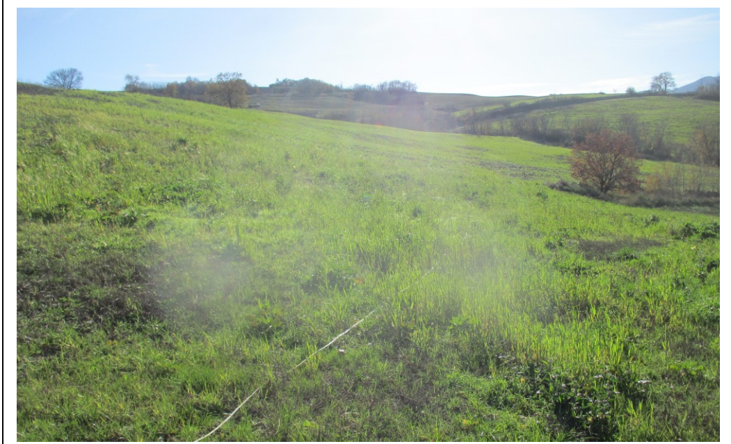
Esecuzione indagine sismica a rifrazione n. 2 e Masw n. 2 sullo stesso stendimento
