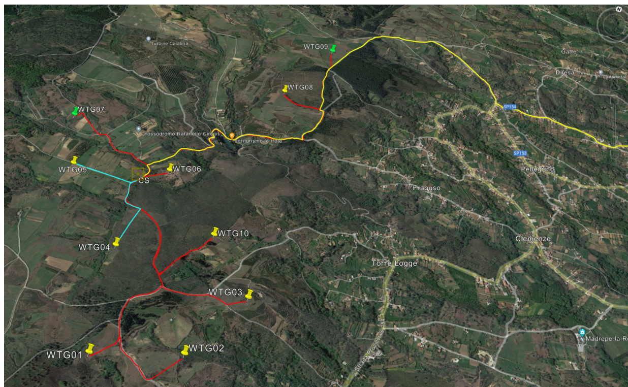
Figura 3 – indicazione dei punti di installazione e del percorso dei cavidotti tra gli aerogeneratori
