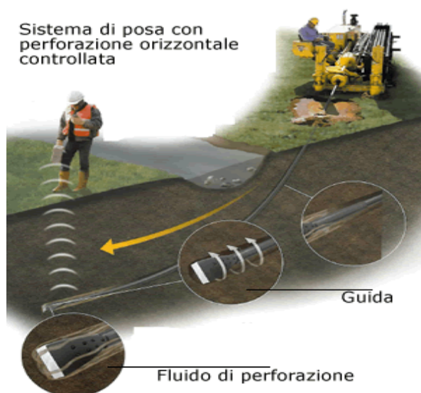
Figura 10 Sistema di trivellazione orizzontale controllata (T.O.C.).
