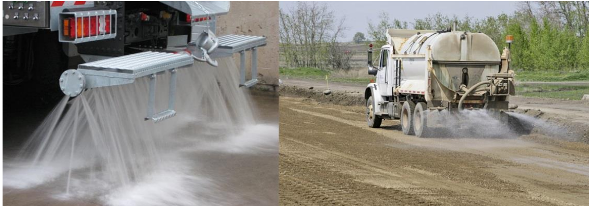
Figura 5-3: Automezzo per la bagnatura delle piste sterrate
