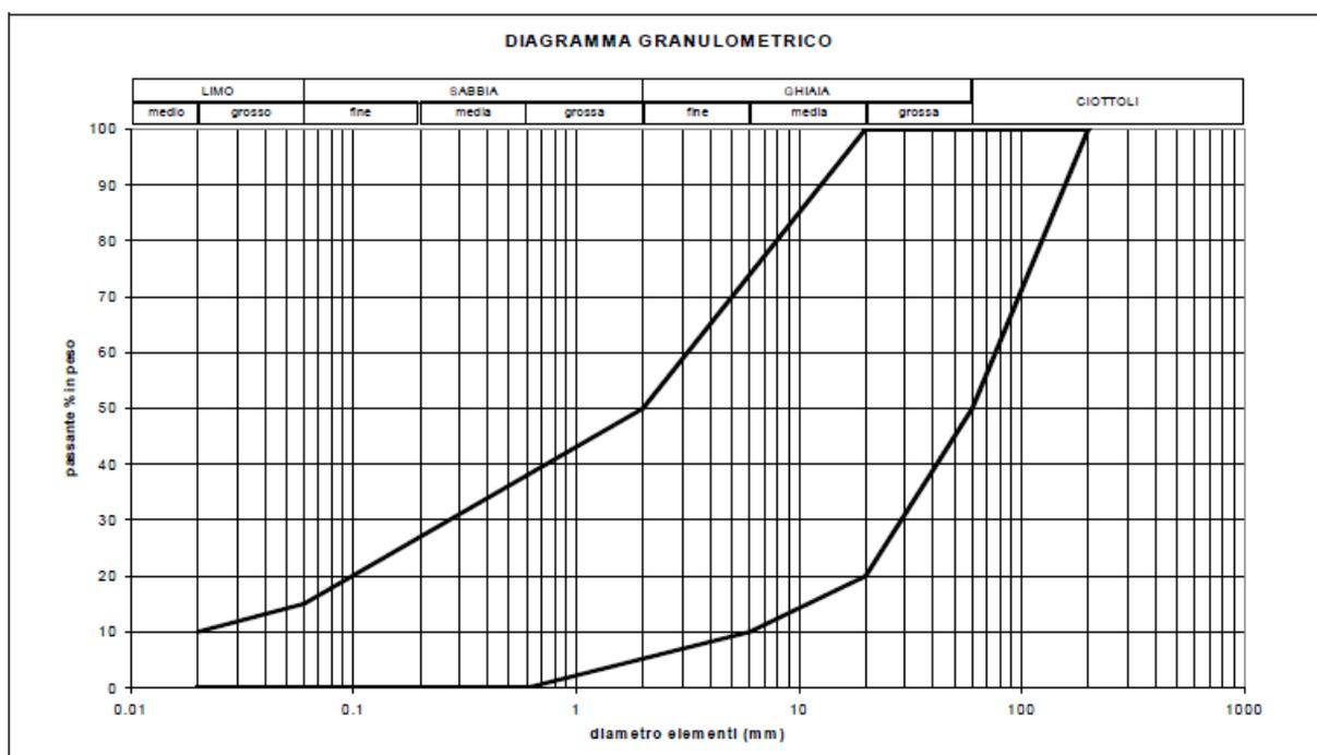
Figura 5.1: fuso granulometrico per materiale da rilevato
