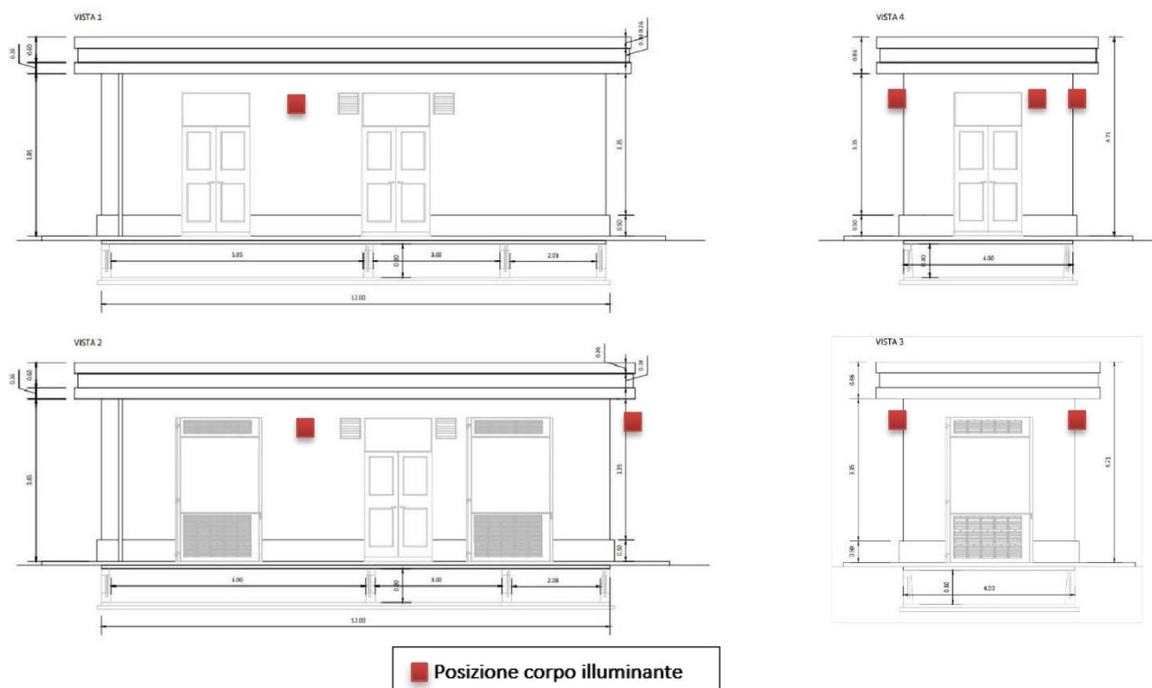
Figura 3.1: Tipologico Cabina di campo con indicazione della posizione dei corpi illuminanti
