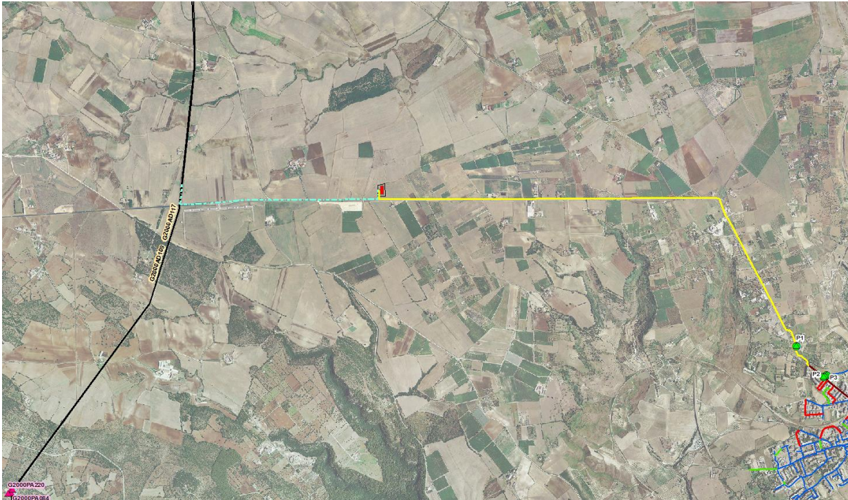
Figura 2 - Interventi di progetto della rete idrica di adduzione: in giallo la suburbana.
