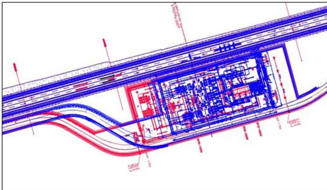
**Figura 3 Sovrapposizione planimetrica tra la configurazione approvata di variante 004 (rosso) e quella in variante 035 (blu)**
