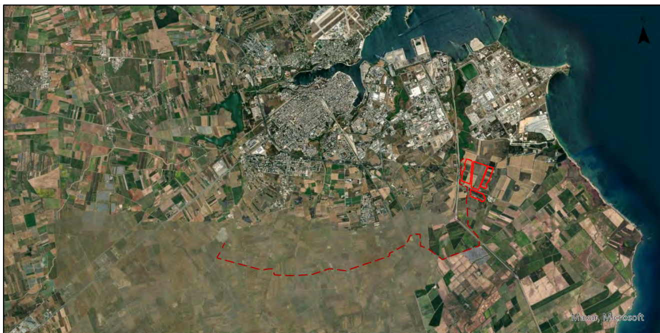
Figura 3-1 Percorso del Cavidotto interrato
