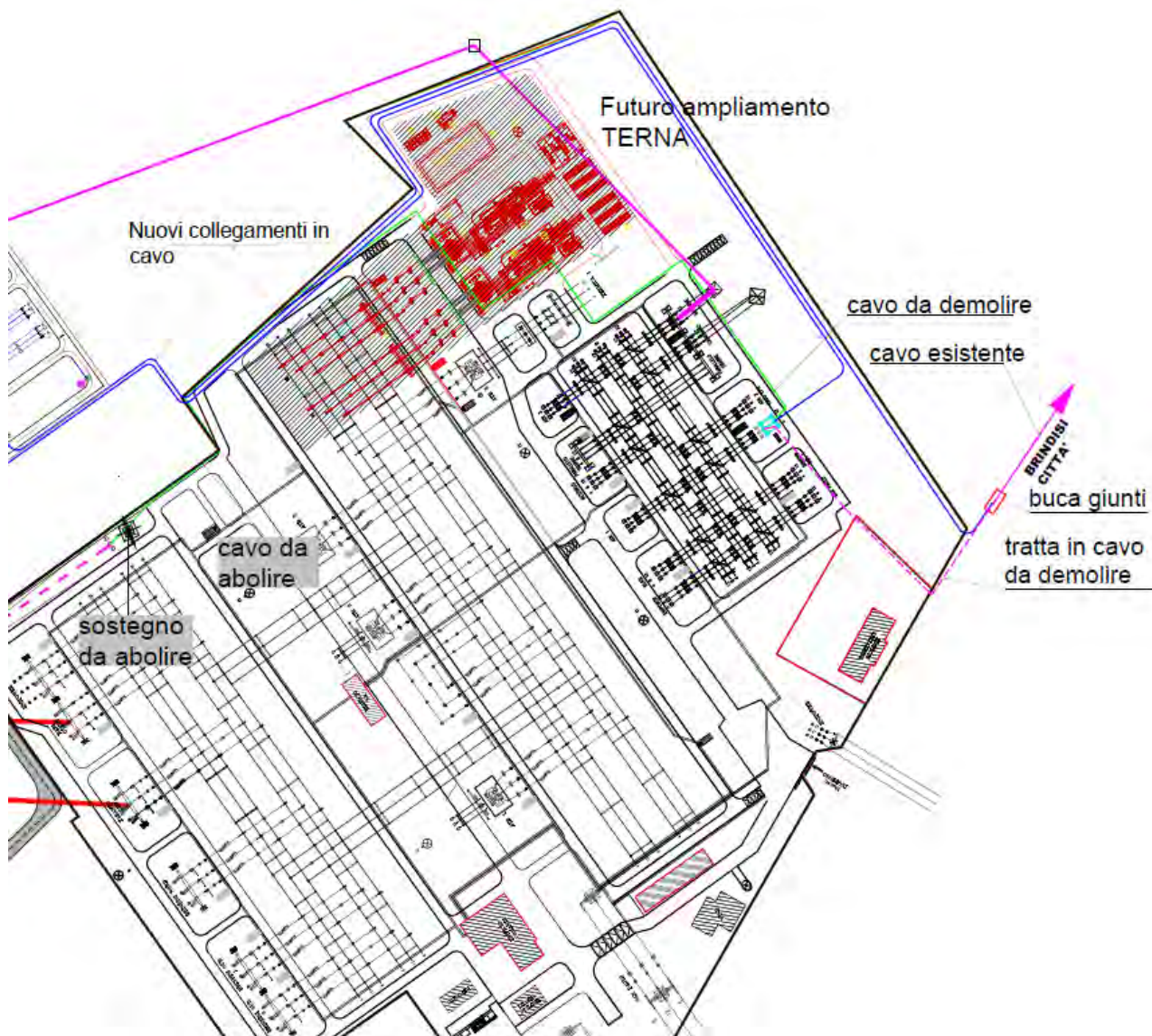
Figura 3-14 - Ampliamento Stazione Elettrica Terna 380/150 kV "Brindisi Pignicelle"
