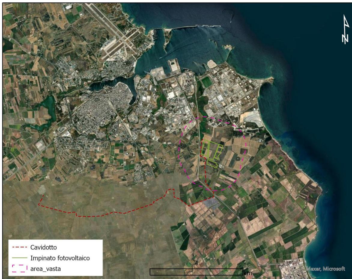
*Figura 3-1: Inquadramento territoriale dell'impianto fotovoltaico in progetto. La linea tratteggiata indica l'estensione dell'area vasta mentre la linea continua l'estensione dell'area di progetto formata da 9 campi fotovoltaici.*
