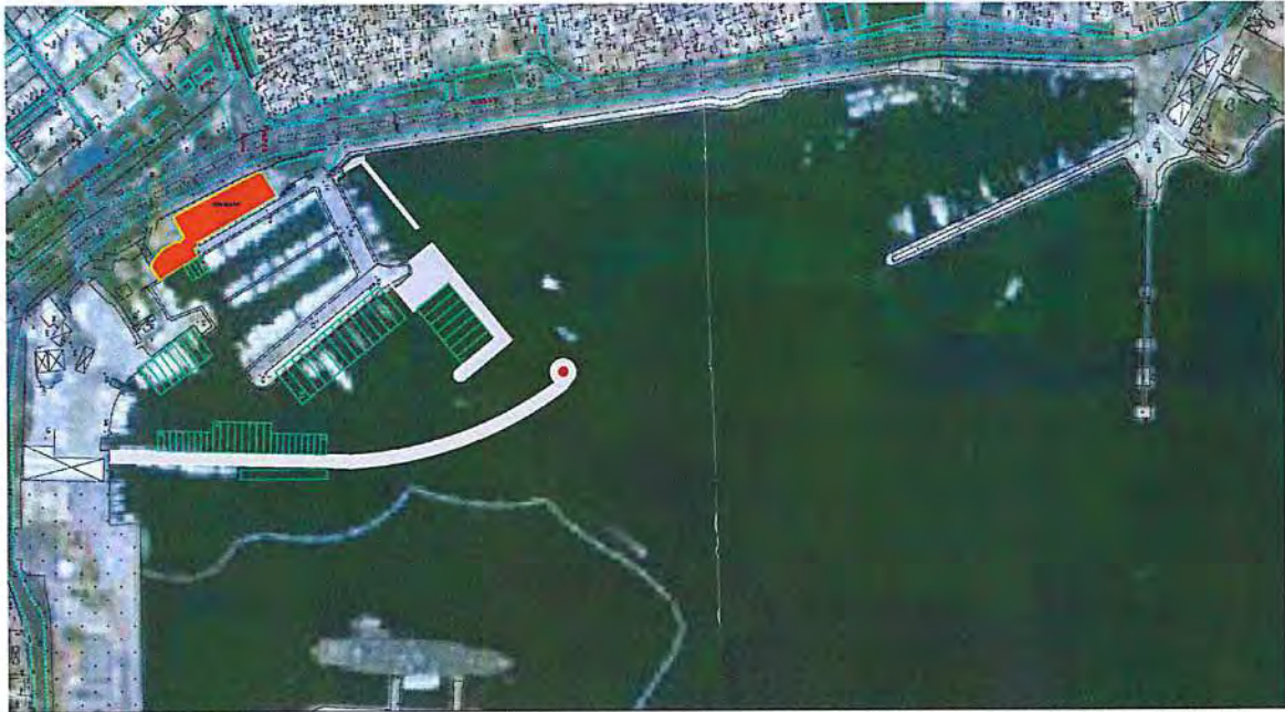
Figg.30.5 – L'alternative progettuale 3, scartata per l'eccessiva lunghezza del molo di sopraflutto
