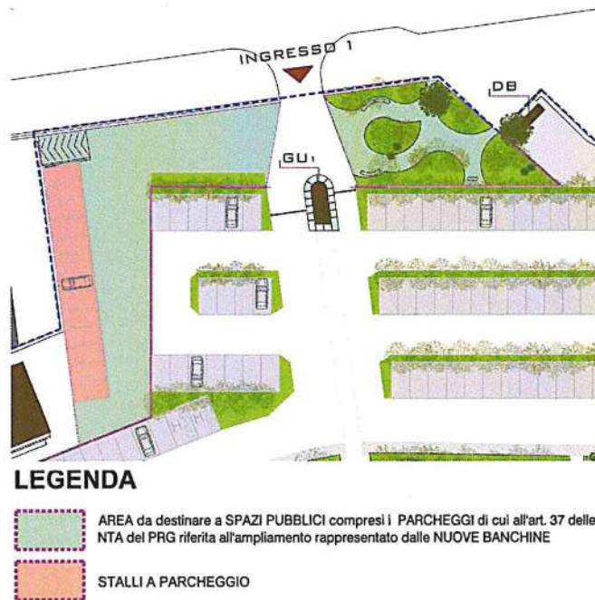
Fig.3.03 – Opere di urbanizzazione a realizzarsi previste: area a verde e stalli di parcheggio nei pressi dell'ingresso 1
