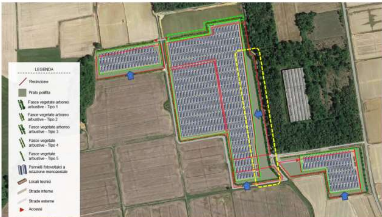
Figura 1: Nuovo layout di progetto in cui si evidenzia la riduzione dell'ingombro previsto per la componente fotovoltaica (il perimetro rosso si riferisce all'area recintata prevista in prima istanza, il perimetro verde la nuova aerea recintata. La linea tratteggiata verde evidenzia le mitigazioni che potranno essere eliminate in fase di dismissione, la linea tratteggiata gialla le aree dalle quali è stato escluso il rimboscimento proposto in prima istanza, le frecce blu evidenziano le porzioni in cui è stata arretrata la recinzione.
