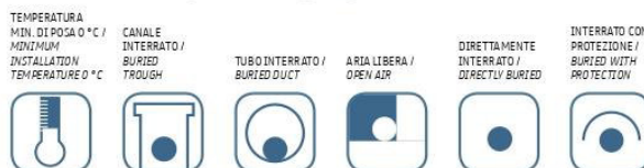
Figura 12: Dati Tecnici generali del cavo
