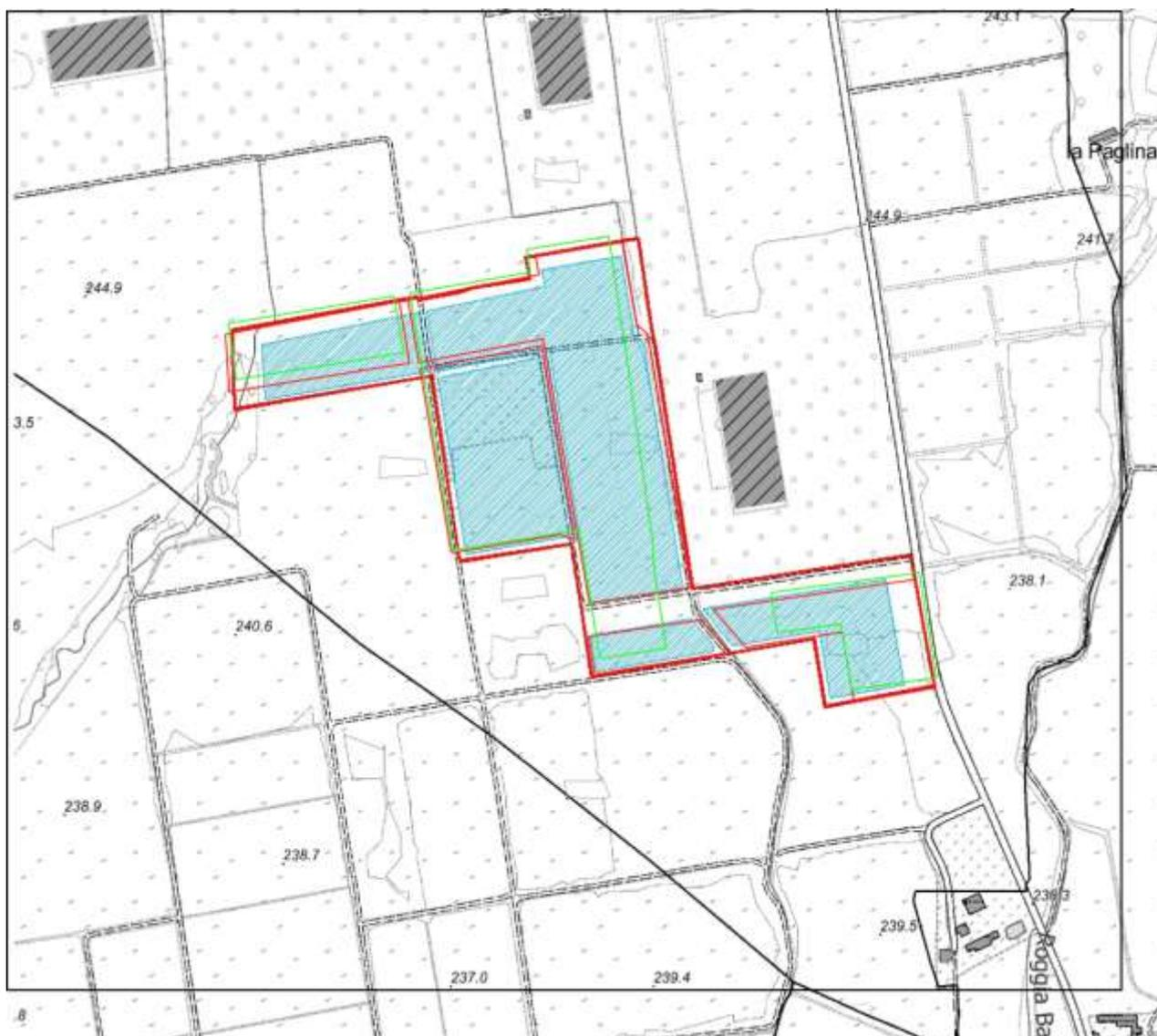
Figura 9 Inquadramento di dettaglio su C.T.R. (immagine fuori scala); in rosso sono individuate le aree in proprietà, in azzurro le aree in cui si prevedeva la realizzazione dell'impianto fotovoltaico, in verde il nuovo layout
