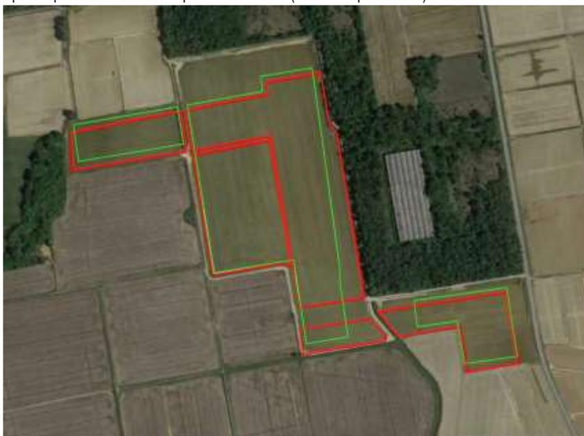
Figura 12 Inquadramento su foto aerea: in rosso l'area recintata nel layout originale, in verde l'area recintata con il nuovo layout (fonte: Google Earth®, data acquisizione immagini 05/08/2020).
