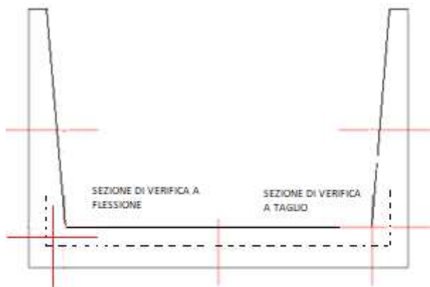
Figura 9 – Sezioni di verifica
