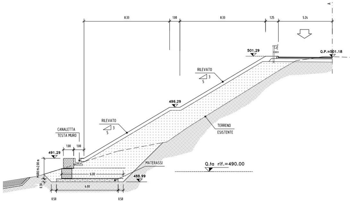
Sezione muro in terramesh System: H = 2.00 m
