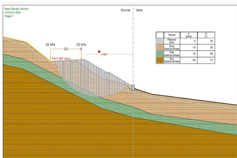
**Condizioni Statiche: Fase di esercizio – Superficie Critica di Scorrimento massima muro H=2.00 m**
