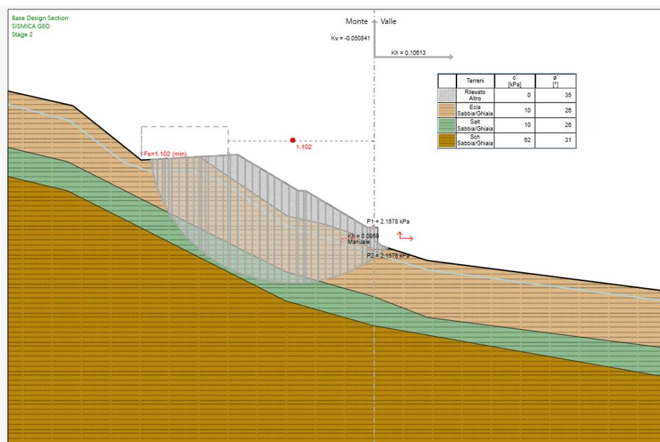
**Condizioni Sismiche: Fase definitiva – Superficie Critica di Scorrimento massima muro H=3.00 m**
