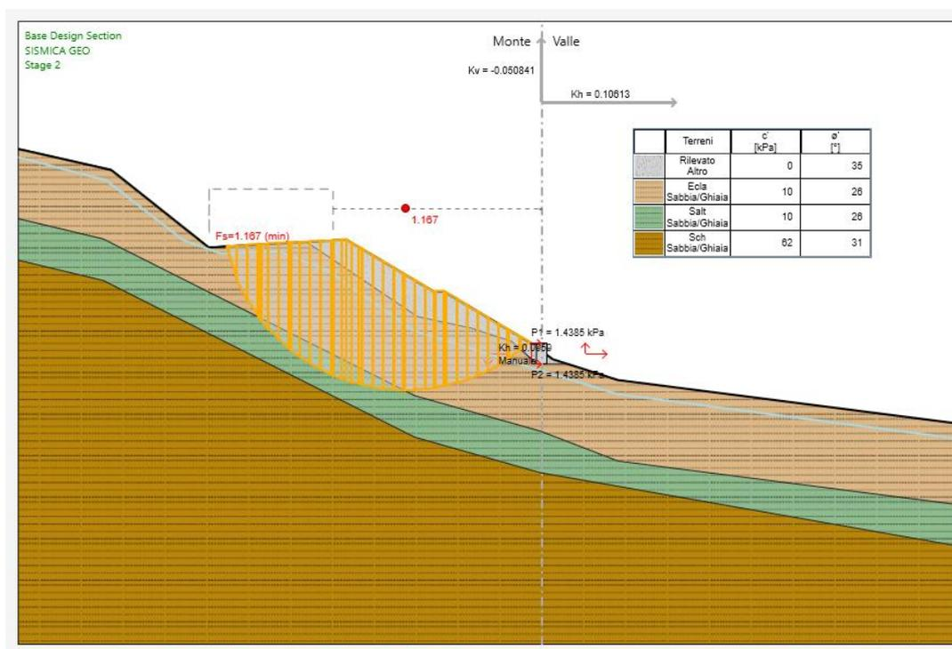
**Condizioni Sismiche: Fase definitiva – Superficie Critica di Scorrimento massima muro H=2.00 m**
