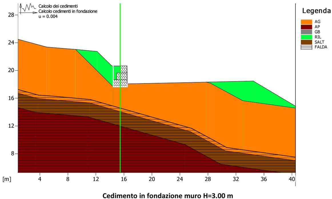
Come si evince dal diagramma sopra riportato il cedimento in fondazione massimo è pari a 4.5 mm. Tale cedimento risulta compatibile con la funzionalità dell'opera.
