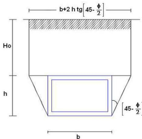
Più in dettaglio **Terzaghi** fornisce due espressioni differenti della pressione a seconda della maggiore o minore altezza del ricoprimento,  $H_0$ .
