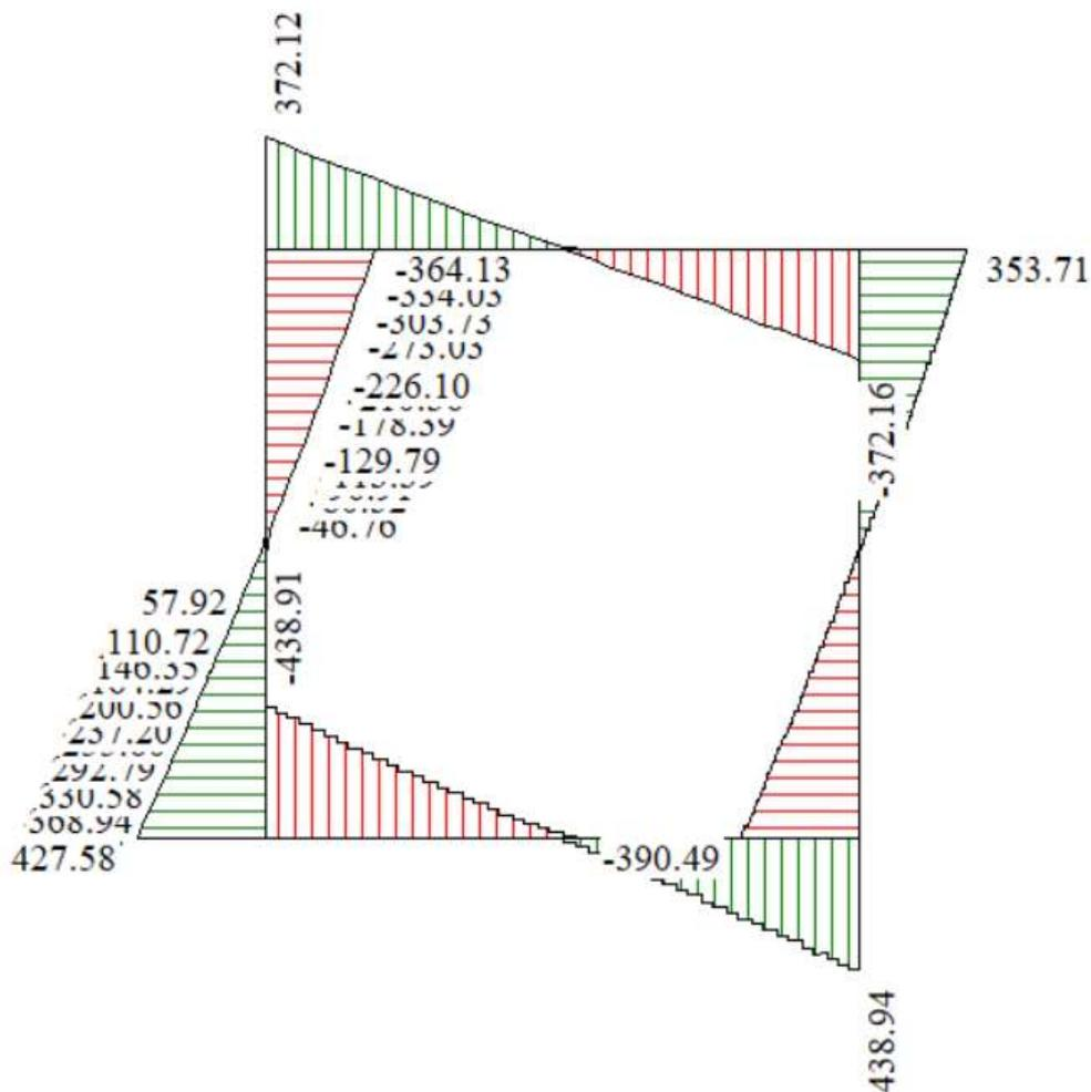
Involuppo diagrammi del taglio flettente – SLU statico e sismico
