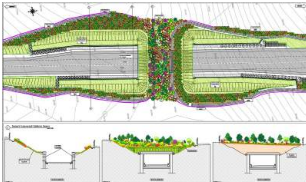
Dettaglio Galleria Artificiale Seano - Tavola TVI03B
