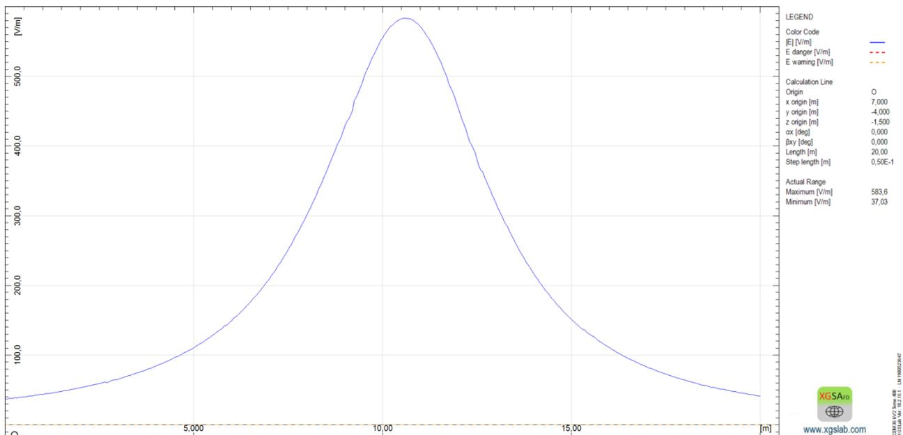
**Profilo del Campo Elettrico sulla sezione dei cavi di vettoriamento MT a 1,5 m dal suolo**
