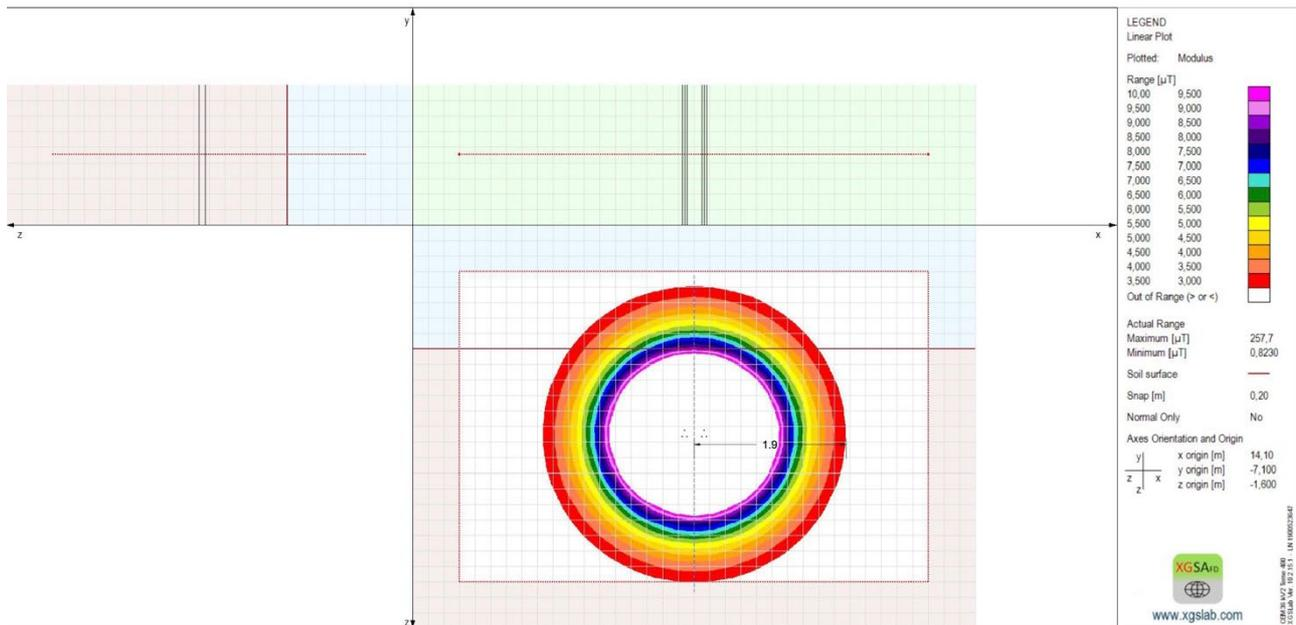
**Calcolo induzione magnetica sulla sezione dei cavi di vettoriamento MT**
