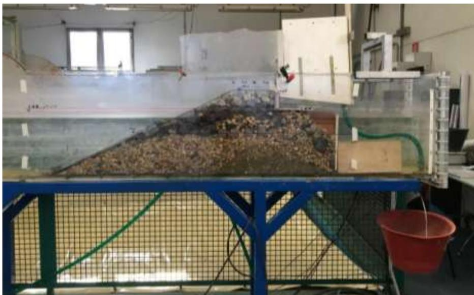
**Figura 18:** Foto della diga con vasca di dissipazione riempita in massi rocciosi 48-83 g (7 – 12 t in prototipo)
