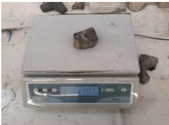
**Figura 10** Bilancia di precisione per la selezione degli elementi della mantellata
