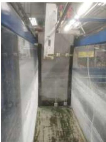
**Figura 4:** Vista prospettica del generatore di moto ondoso con le due sonde per l'assorbimento attivo
