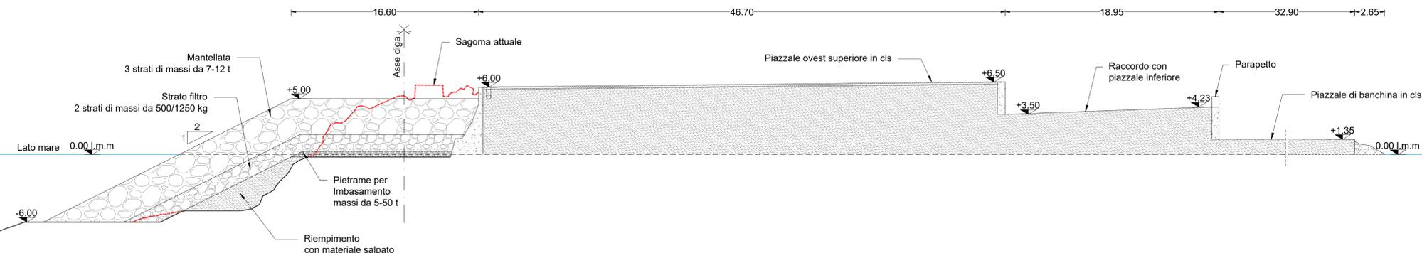
6 Sezione tipologica del piazzale ovest superiore
