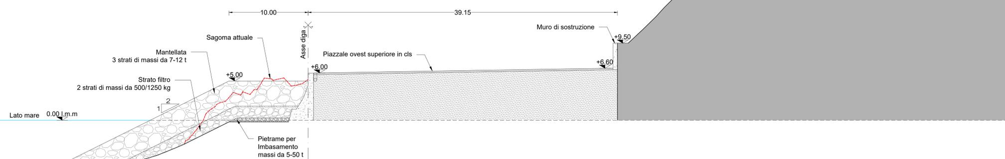
7 Sezione tipologica del piazzale ovest superiore
