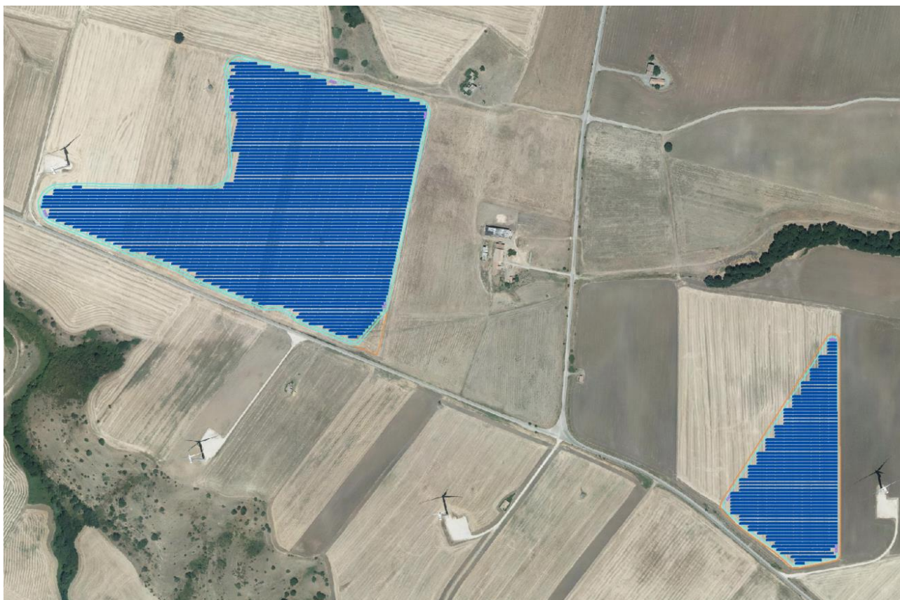
Figura 4.5. – Layout del sistema fotovoltaico con supporti fissi.
