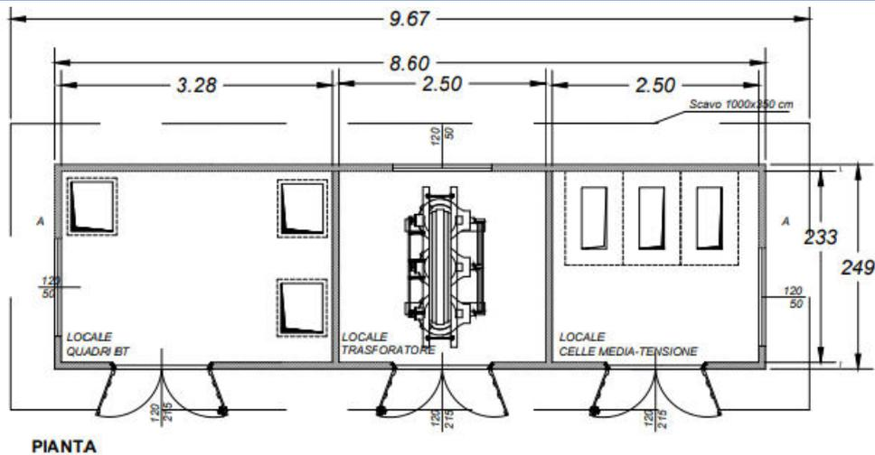
Figura 6.9. – Schematizzazione in pianta cabina di trasformazione.
