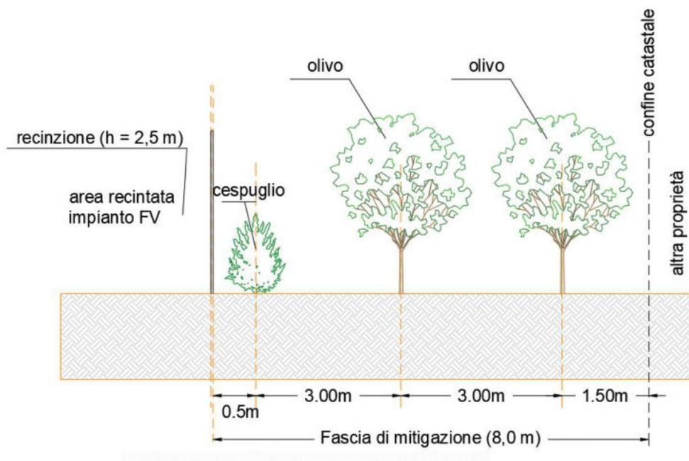
Figura 14.3. – Stralcio di sezione dell'area perimetrale dell'impianto.
