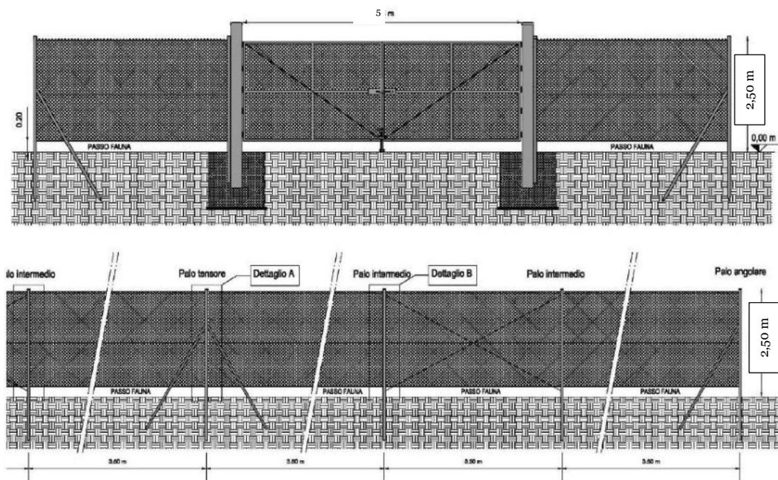
Figura 6.12. – Cannello di accesso e recinzione impianto agrivoltaico.
