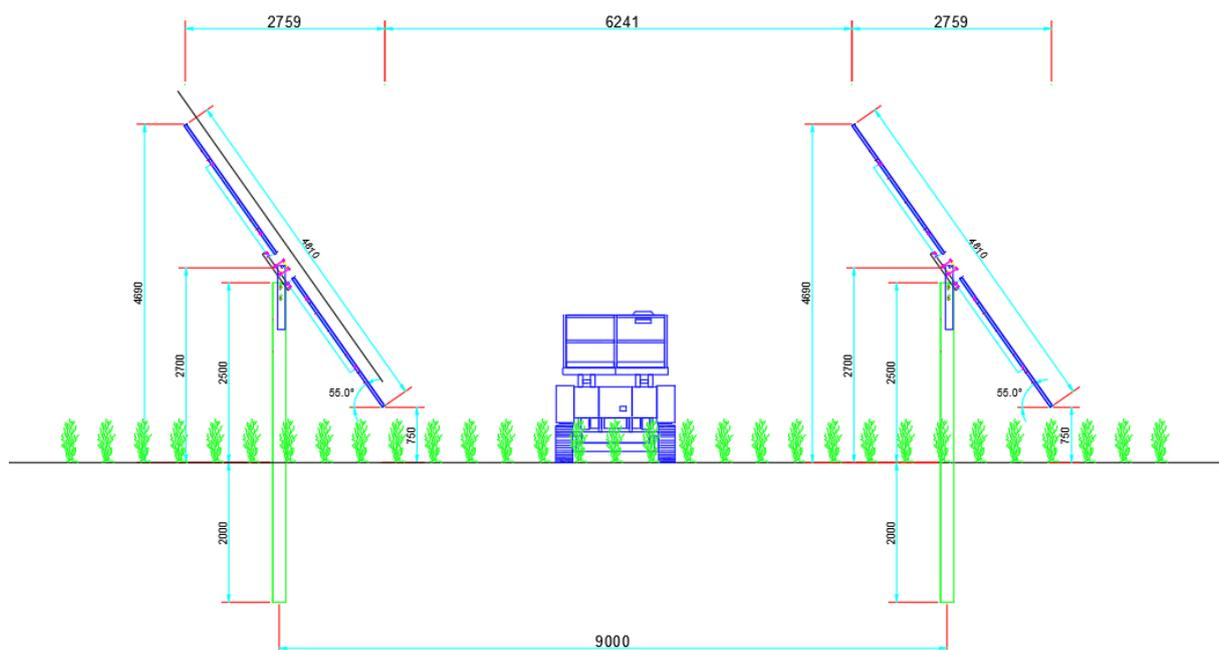
Figura 2.3. – Area di insidenza minima del modulo fotovoltaico.
