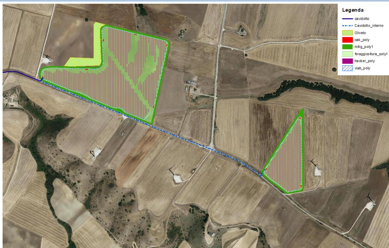
Figura 2.1 – Area di progetto con indicazione degli interventi agronomici e posizionamento dei moduli fotovoltaici.
