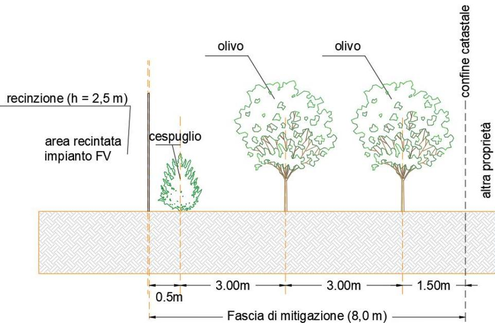
Figura 2.13. – Stralcio di sezione dell'area perimetrale dell'impianto.
