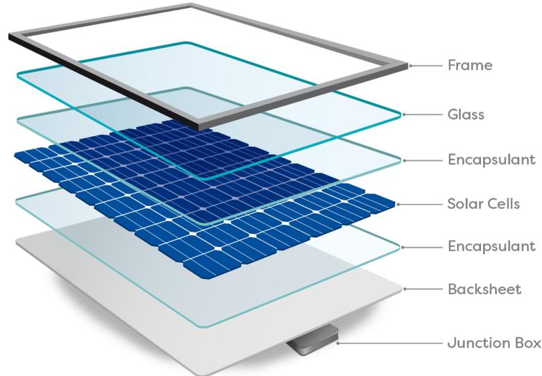
Figura 11 - Stratigrafia di un pannello in silicio cristallino
