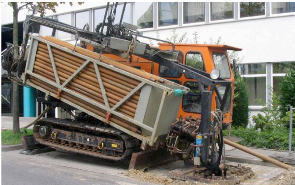
Figura 6-4 – Esempio tipo di perforatore orizzontale
