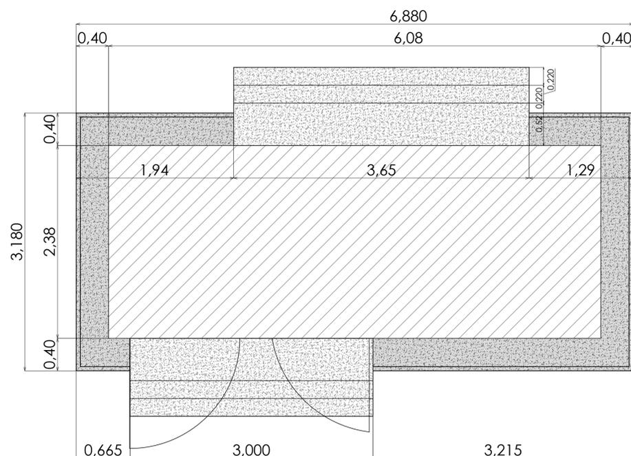
La struttura dei box è realizzata utilizzando un calcestruzzo Rck 400 Kg/cm<sup>2</sup> - C 32/40 additivato con idonei fluidificanti e impermealizzanti per fornire protezione contro le infiltrazioni d'acqua dall'esterno. L'armatura è realizzata con rete elettrosaldata a doppia maglia, irrigidita agli angoli con barre a doppio T.
