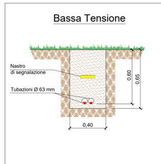
Particolare passaggio cavi bassa tensione Scala 1:20
