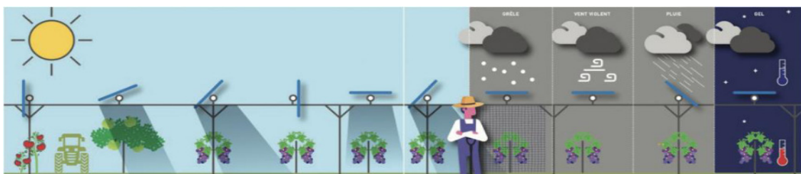
Figura 33. Illustrazione tipologica del funzionamento di un sistema Agrivoltaico (Fraunhofer, 2020).
