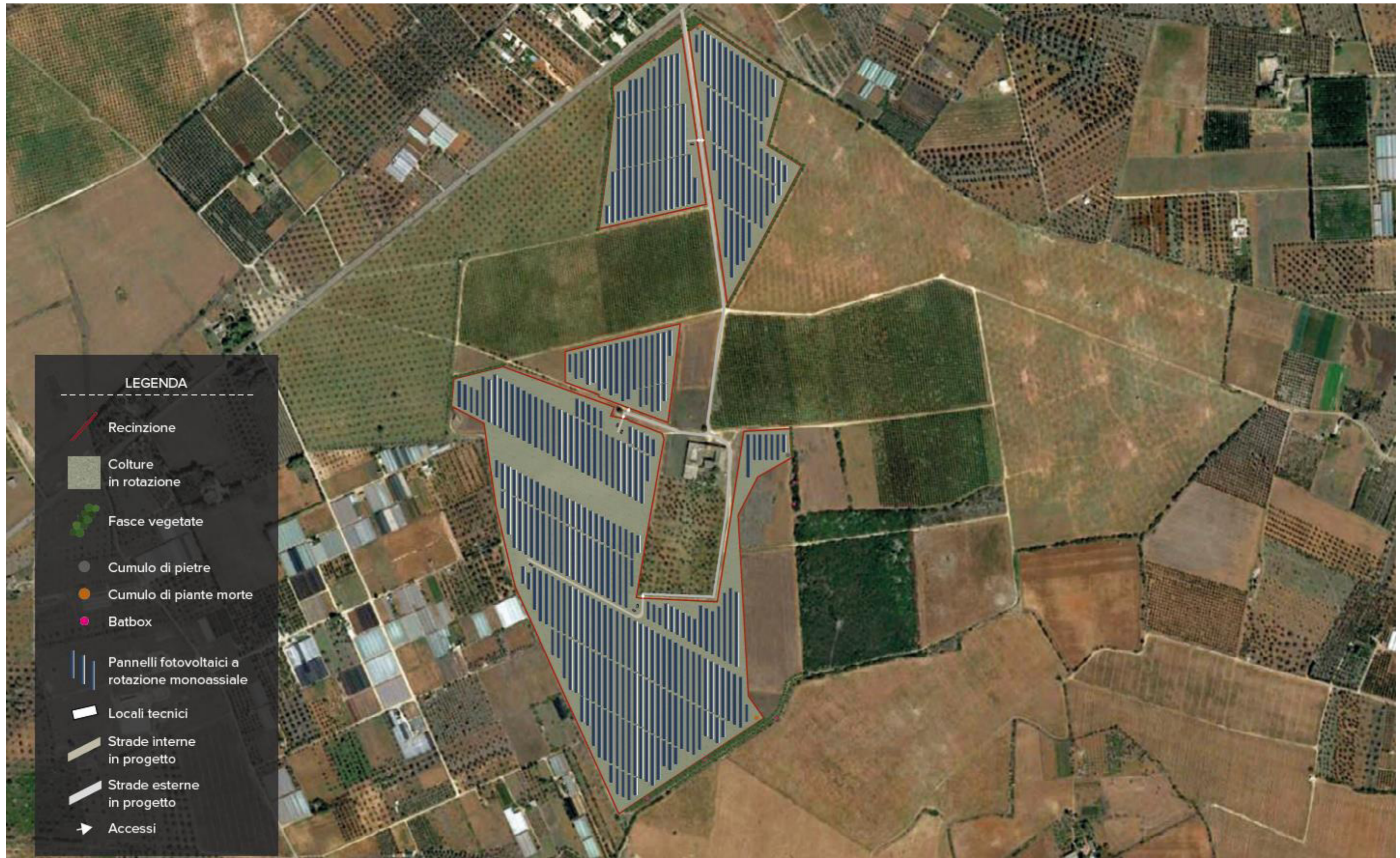
Figura 80. Layout relativo alle opere in progetto, con rappresentazione grafica della componente ambientale (colture in rotazione, fasce arboreo-arbustive, micro habitat per la fauna locale) e della componente tecnologica (pannelli fotovoltaici, strade e locali tecnici).
