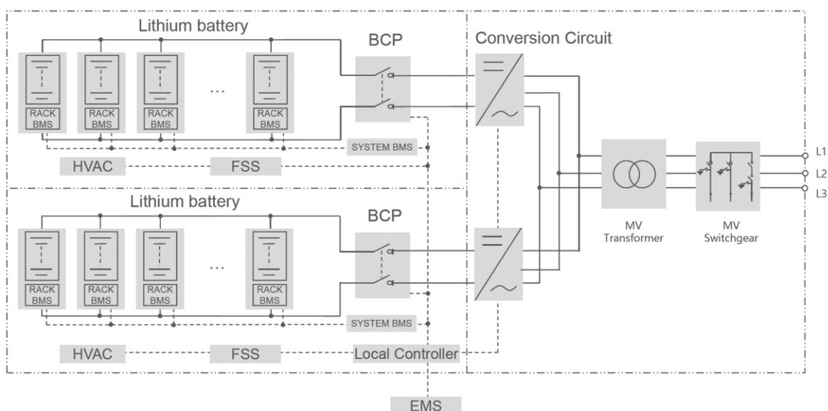
Figura 3 – Schema funzionale singolo battery block
