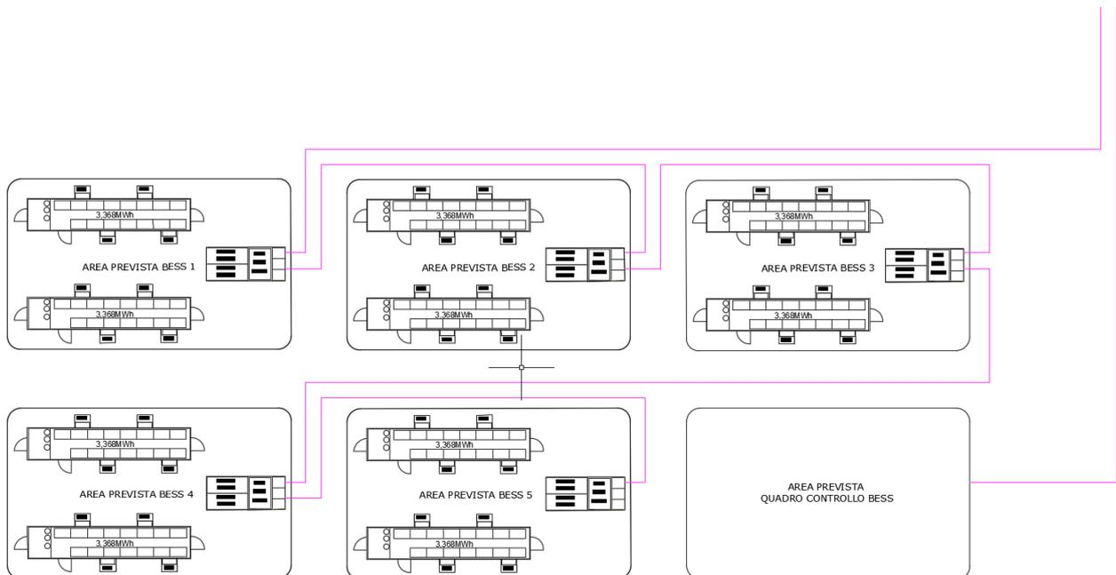
Figura 5 – Layout dell'impianto BESS all'interno dell'area disponibile
