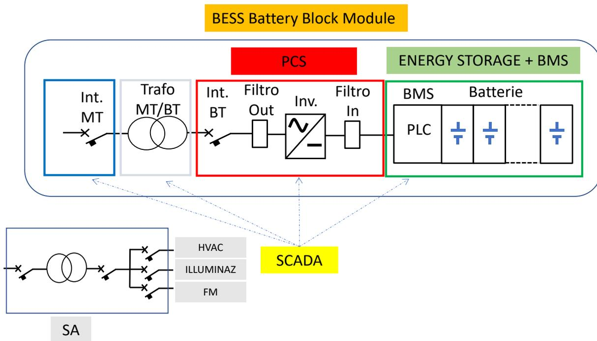
Figura 1 – Configurazione di un BESS battery block
